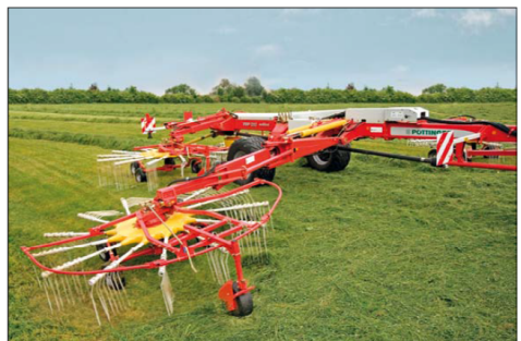
U shrnovače TOP 1252 si v Jetřichovci pochvalují možnost plynulé změny pracovního záběru z kabiny a nezávisle na tom i možnosti regulace šířky odkládaného rádku
