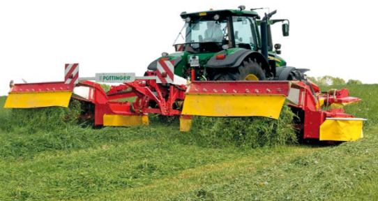
NovaCat X8 ED s pracovním záběrem 8,3 m zvládne i v členitých podmínkách posekat 50-60 hektarů trvalých travních porostů denně
