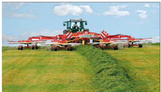
V práci se ukázalo, že velký čtyřrotorový shrnovač formuje vhodný rádek pro následný sběr senážními návěsy
