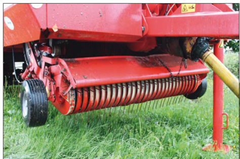
Sběrač vozu Faro 8000 má šířku 1850 mm. Při sběru hmoty dochází díky vodícím plechům k oddělení krmiva od nečistot. Oboustranné vedení prstů snižuje jejich zatěžování i míru znečištění hmoty
