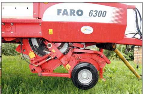
Návěsy Faro mají plnicí válec poháněný jednoduchým válečkovým řetězcem. Dostatečně dimenzovaná robustní převodovka se síčnými ozubenými koly zajišťuje spolehlivý přenos výkonu od traktoru po plynulé plnění i při sběru značně nerovnoměrných rádků
