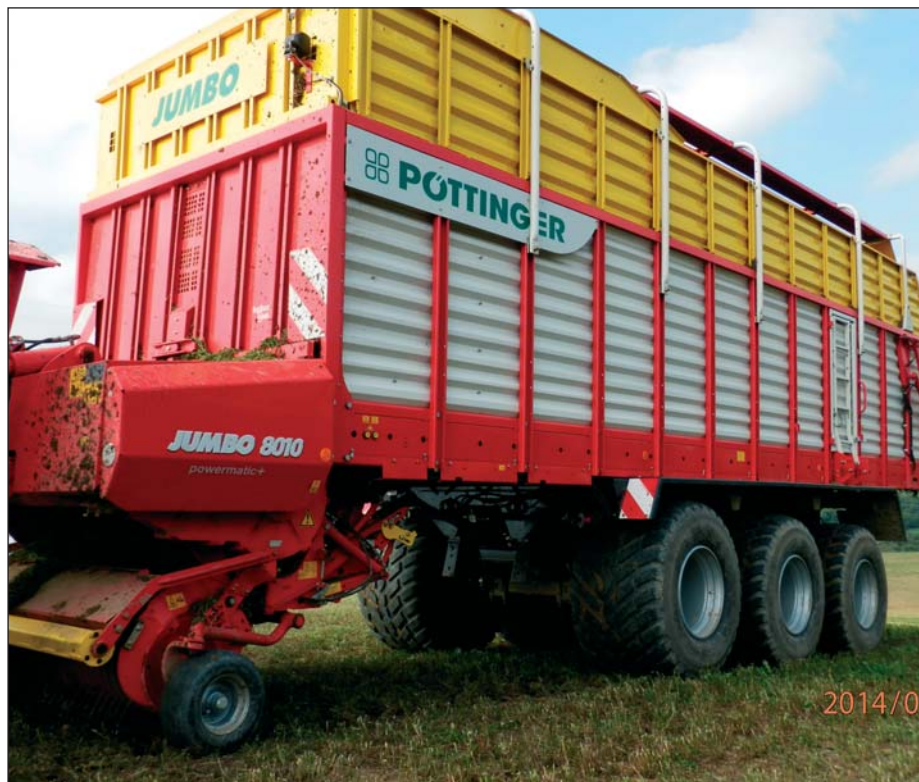
Široké pneumatiky tiež znižujú tlak na pôdu a zabezpečujú vyššiu stabilitu.
