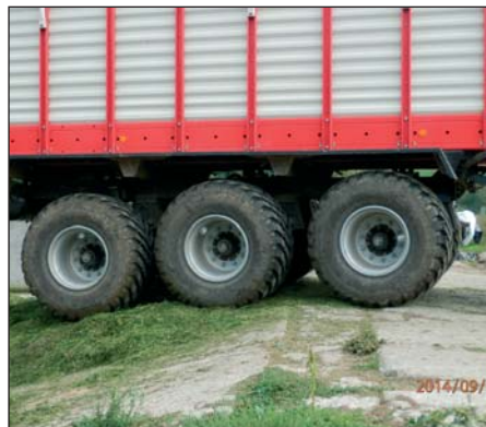
Špeciálny hydro-pneumatický tridem podvozok.
