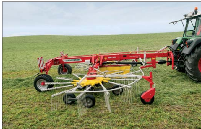
TOP 762 C – dvojrotorový stredový zhrňovač s pracovným záberom 6,7 – 7,5 m.
