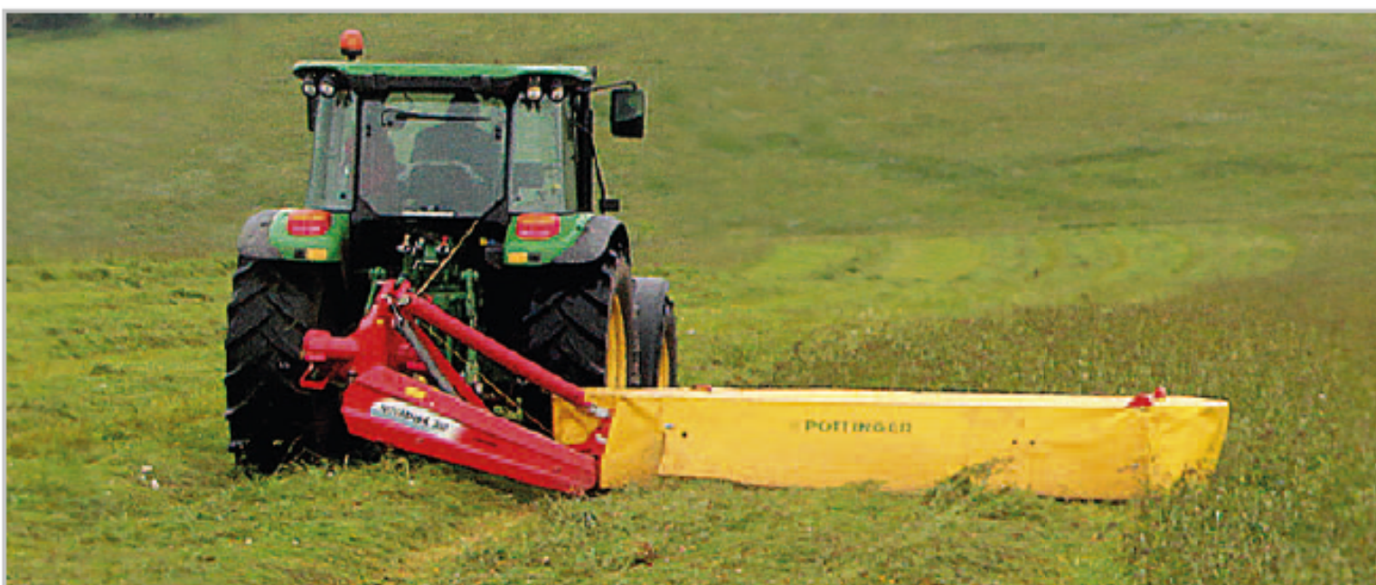
Spokojeným uživatelem Novadisc 350 je i Miroslav Hlaváček z Boleboře na Chomutovsku. Stroj s pracovním záběrem 3,5 m pracuje v agregaci s traktorem o výkonu 80 koní Foto archiv firmy
