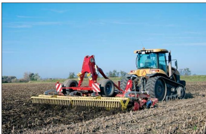
Diskový podmietač PÖTTINGER Terradisc 6001 T využívajú na spracovanie pôdy hlavne po kukurici.
