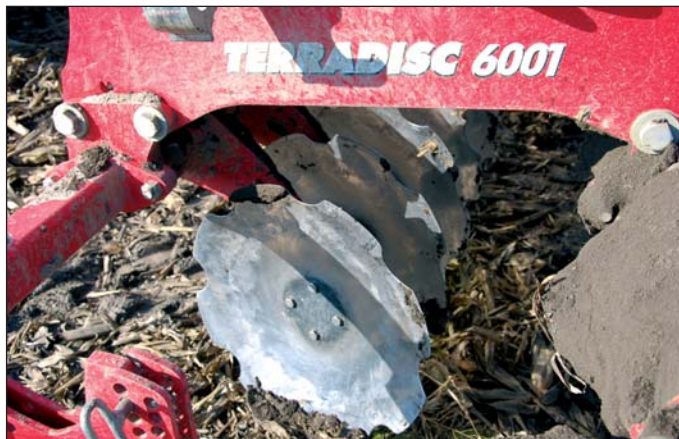
O spracovanie pôdy sa starajú disky s priemerom 580 mm, ktoré na tunajšom podniku veľmi dobre zapracúvajú pozberové zvyšky po kukurici.
