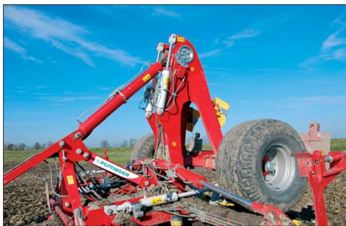
Náprava je pre lepšie rozloženie hmotnosti a doťaženie pri pracovnej pozícii sklopená nad valec a pracovné ústrojenstvo.
