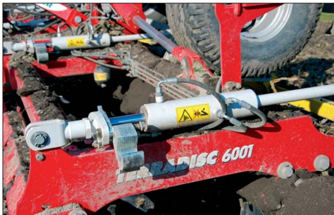
Jednoduché a rýchle nastavenie hĺbky spracovania pomocou sklopných dorazov je umiestnené v prednej časti na ľahko dostupnom mieste.
