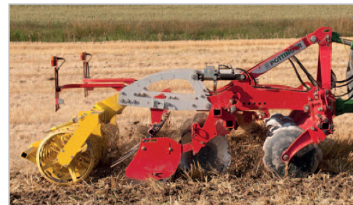
Terradisc jsou určeny ke zpracování půdy do hloubky od 3 do 15 cm, to znamená především pro podmítku, přípravu setového lůžka nebo i k zapravování kejdy Foto archiv firmy
