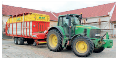
Návěs Faro 8000 L mají malou energetickou náročnost a postačovali by traktor o výkonu 115 k. V Klučnicích pracují s traktorem John Deere 7530 Premium o výkonu 175 k, který je hravě zvládá. Další výhodou je větší průměrná přepravní rychlost
