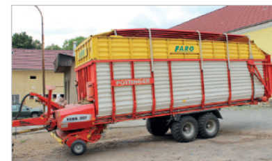
Kombinace velkého objemu ložné plochy, vybavené v horní části stropními profily, s pícním rotorem se u návěsu Faro ukázala jako zdařilá. Díky vysoké rychlosti plnění je až pět tun slámy či sena naloženo během krátké doby. Výkonnost a komfort práce zvyšuje automatika plnění i vyložení
