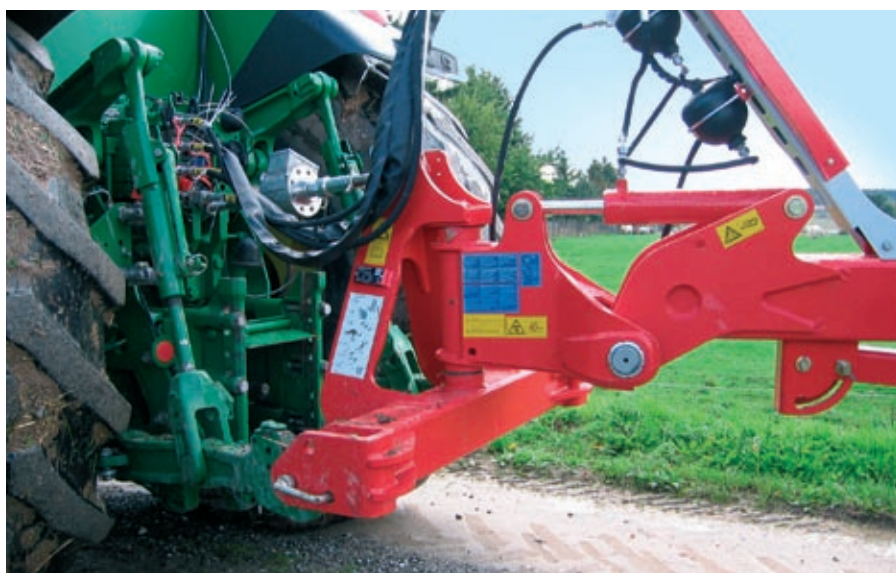
Dotěžování zadní nápravy traktoru systémem Traction Control.
