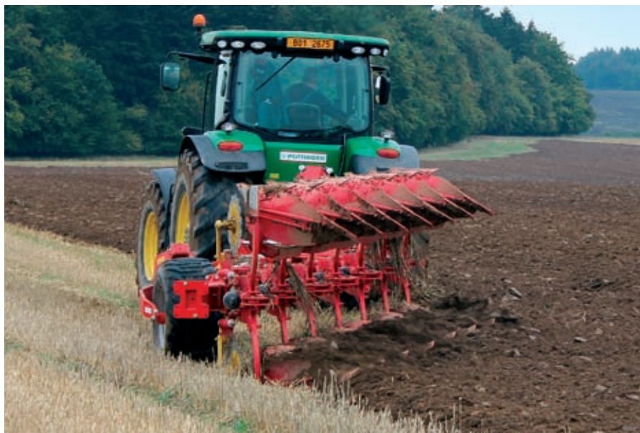
Orební souprava: traktor John Deere 8295R se sedmiradličným návěsným pluhem Pöttinger SERVO 6.50.
