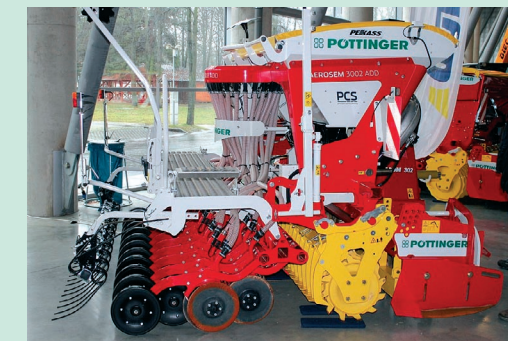
SEČÍ STROJ PÖTTINGER AEROSEM 3002 ADD S OVLÁDÁNÍM JEDNOTLIVÝCH VÝVODŮ SEMENOVODŮ A OPTICKOU KONTROLU POHYBU SEMEN PŘI SETÍ NA KONEČNOU VZDÁLENOST.
