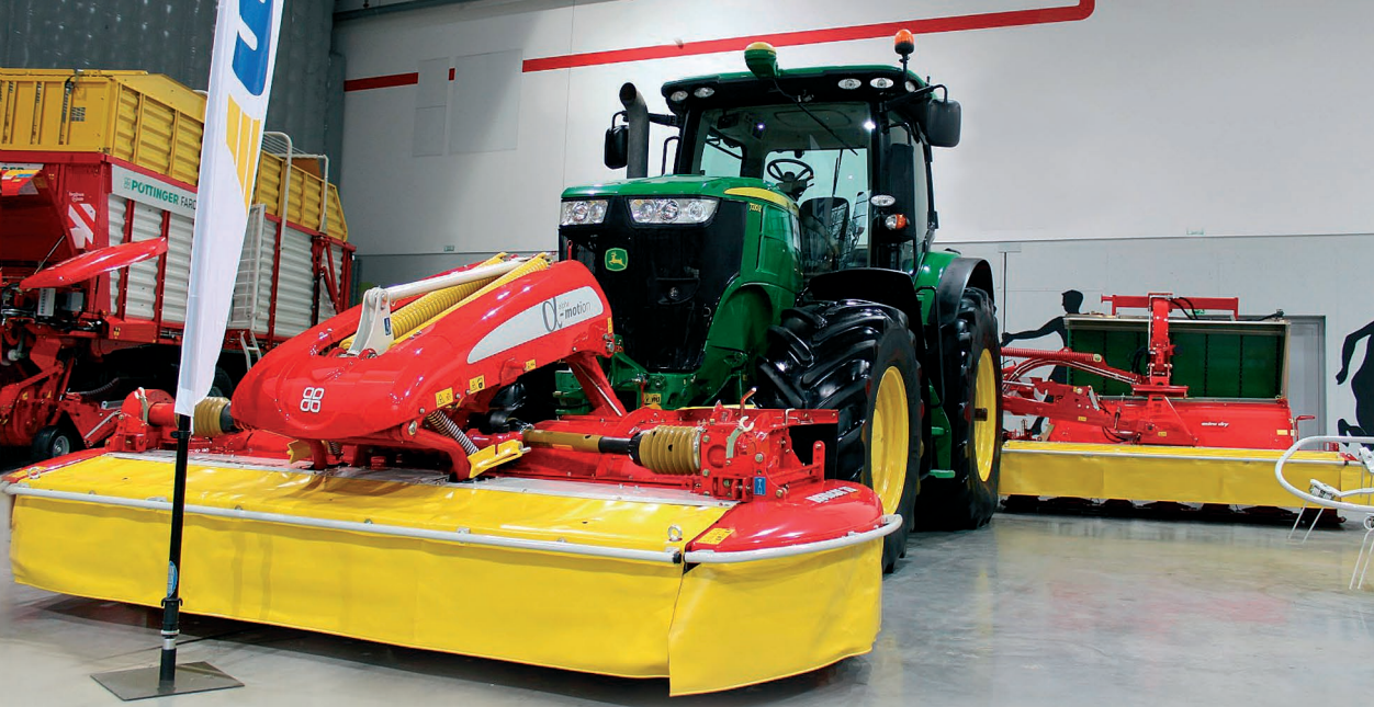
ŽACÍ KOMBINACE PÖTTINGER NOVACAT X8 ED COLLECTOR V AGREGACI S TRAKTOREM JOHN DEERE 7230R COMMANDQUAD, KTERÝ ZAJISTÍ DOSTATEK VÝKONU I V KOPCOVITÉM TERÉNU.
