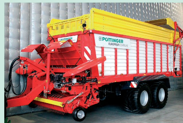
KOMBINOVANÝ NÁVĚS PÖTTINGER EUROPROFI 5510 COMBILINE JE VYBAVEN ŘEZACÍM ÚSTROJÍM S OBOUSTRANNĚ NABROUŠENÝMI NOŽI.
