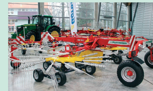
PÖTTINGER TOP 762 C JE MODEL STŘEDOVÉHO SHRNOVAČE S ŘÍZENOU NÁPRAVOU A S MECHANICKÝM NEBO HYDRAULICKÝM NASTAVOVÁNÍM PRACOVNÍHO ZÁBĚRU.
