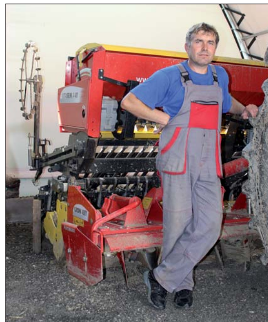
„Mechanický nástavbový secí stroj Vitasem A 401 se při zakládání porostů obilnin a ozimé řepky v těžkých půdách osvědčuje dodržováním hloubky setí i podélného rozdělení osiva,“ pochvaloval si Miroslav Steinbauer
