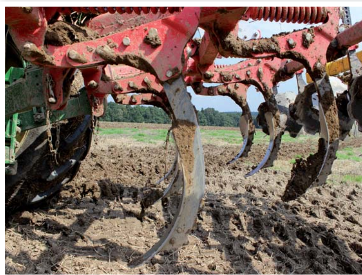
U kypřičů Synkro je celá konstrukce zaměřená na stabilitu. Platí to i o držácích slupic, které jsou prohnuté směrem dolů pro zajištění stabilního uchycení. Synkro Nova má dvě možnosti nastavení úhlu radliček
