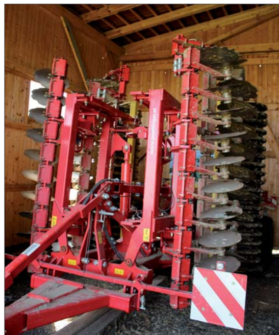
Talířový podmítač Terradisc 4000 T slouží nejenom k podmínkám, ale i pro přípravu půdy před setím. Těžký gumo-ocelový opěrný válec provádí účinnou konsolidaci půdy a drcení hrud
