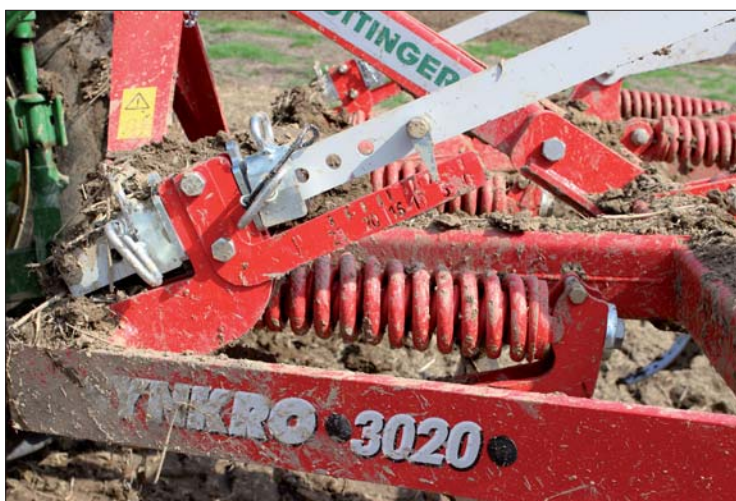
U nových kypřičů Synkro 1020 se nastavení pracovní hloubky radliček provádí na boku jednoduše pomocí kolíku a děrné lišty
