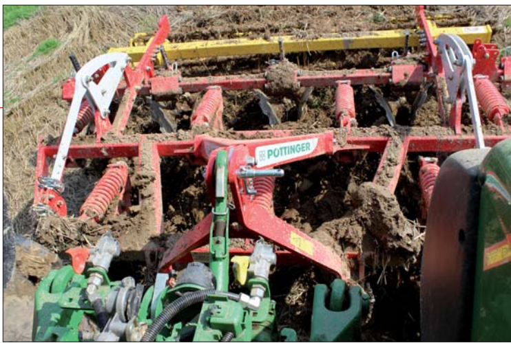
Při pohledu z místa spolujezdce je patrný volný prostor mezi jednotlivými radlicemi i mezi nosíky kypřiče. Urovňovací talíře spolu s robustním prutovým válcem se postaraly o urovňání pozemku a rozbití hrud.
