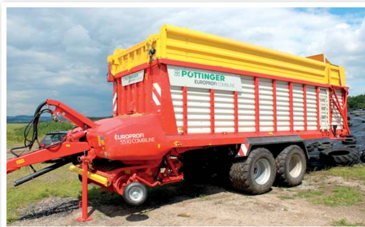
Kombinovaný návěs Europrofi 5510 L Combiline nachází v podniku VOD Lidmovice uplatnění jak při odvozu píce od řezačky, tak při sklizni hůře přístupných luk, kde je zcela samostatný
