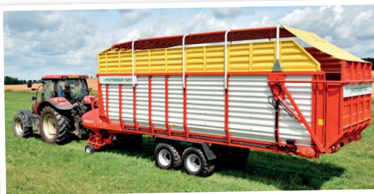
Významnou předností návěsů Faro je jejich malá energetická náročnost, a zároveň i přiměřené nároky na výbavu tažného prostředku. S největším modelem Faro 8010 L pracuje traktor o výkonu 125 k
