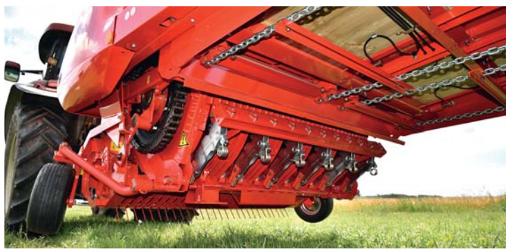
Vůz v podniku VOD Lidmovice sklízí suchou hmotu se šesti noži. Řezací ústrojí návěsu Faro 8010 L může být osazeno maximálně 11 noží v rozteči 135 mm. Po odčištění tlačítkem lze nosník vykloupat do strany, kde jsou nože snadno přístupné obsluze vestoje. Samostatné jištění chrání každý nůž před poškozením kameny
