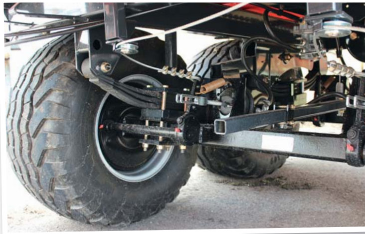
Lehký tandemový podvozek je osazen širokými pneumatikami na ráfcích o průměru 22,5 palce. Stabilní odpružení využívá listových pružin a díky vahadlovému uchycení náprav je dosaženo vyrovnávání zatížení náprav při přejíždění větších nerovností
