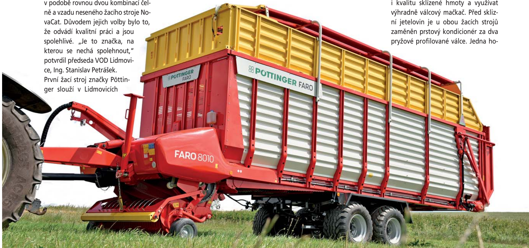
Celých 80 m 3 ložného objemu při středním stlačení na lehkém podvozku a s modernizovaným sběracím a plnicím ústrojím – to jsou nové návěsy Faro „desítkové“ řady firmy Pöttinger
