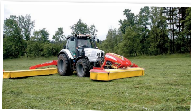
Pro kvalitní kopírování nerovností jsou žací jednotky vybavené hydropneumatickým odpružením
