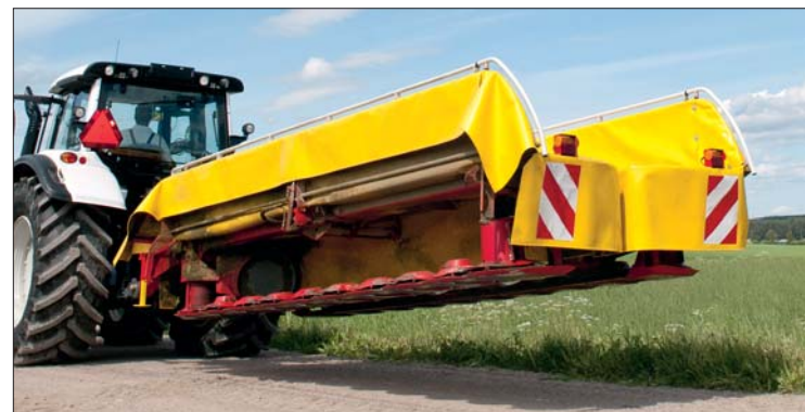
Pro přejezdy se zadním sekcím sklápí ochranné plachty pro dosažení šířky pouhých 2,2 metru, přepravní délka je sice 5 metrů, ale je vyvážená nízkou výškou
