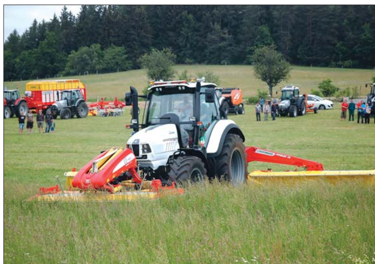
Žací kombinace Novacat S10 se vyznačuje nízkou energetickou náročností a maximální záběrem 9,52 m, čímž konkuruje i samojíždícím žacím strojům
