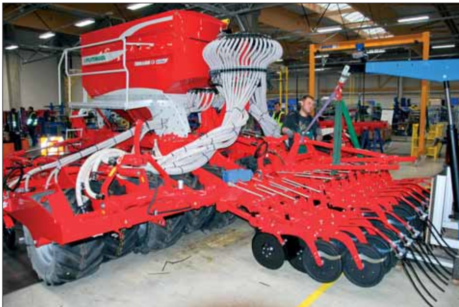
Sejacie stroje Aerosem montujú na 5 stanovištiach, Terrasem a Vitasem na 7.
