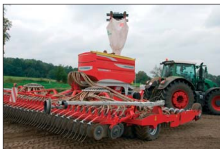
Zásobník na osivo a hnojivo má kapacitu 5100 L.
