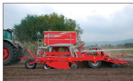
Na ideálnu prácu je potrebná rýchlosť 12 km/h, preto zvolili traktor s výkonom 390 k.
