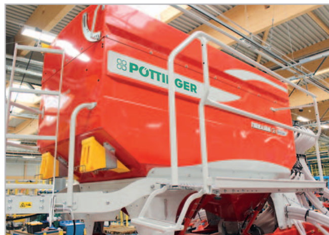
Kombinovaný zásobník secích strojů Terrasem C6 fertilizer má standardně objem 4000 l, ale jak dokumentuje fotografie, na přání jej lze vybavit nástavbou a objem pak stoupne na 5100 l Foto Petr Beneš
