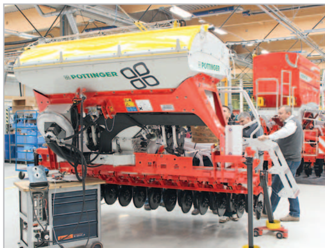
Nejmladším produktem závodu v Bernburgu jsou pneumatické secí stroje Aerosem A řady 1002. Vyrábí se v provedení se záběrem 3; 3,5 a 4 m Foto Petr Beneš
