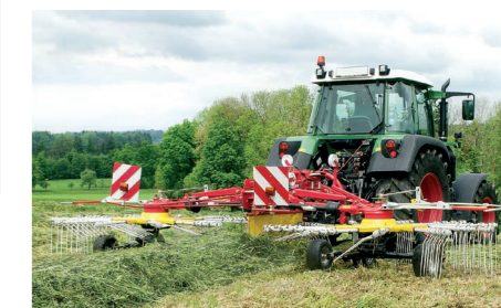
Charakteristickou vlastností středových shrnovačů je šetrná manipulace s píčí a čistá sklizeň. Tyto shrnovače tvoří pravidelný a rovnoměrný řádek vhodný pro následné sklizňové stroje. Nesený dvourotorový shrnovač TOP 612 najde uplatnění především při sklizni malých pozemků.
