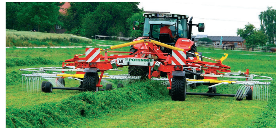
Dvourotorový středový shrnovač TOP 842 C s maximálním pracovním záběrem 8,40 metru je proti svému předchůdci o 1,4 metru kratší a o 450 kg lehčí a má vynikající manévrovatelnost při nízké energetické náročnosti. Konstrukce sklápění rotorů umožňuje dosažení dopravní výšky pouze 3,99 metru, a to bez nutnosti vystupování z kabiny či demontáže ramen.
