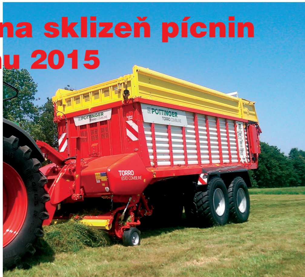
Nový velkoobjemový vůz TORRO combiline je flexibilní vůz pro nasazení podle podmínek – sklizeň senáže nebo doprava objemových materiálů pro bioplynové stanice. Přicházíme s novou řadou vozů s objemem 60 a 65 m 3 . Rozteč nožů 34 mm, výkyvný nosník nožů EASY MOVE s rychloupínáním nožů bez nutnosti využití nářadí, oboustranné nože TWINBLADE, centrální odblokování stropních lanek nebo v přední části snížený ložný prostor nástavby jsou jen některými novinkami v konstrukci vozů TORRO combiline.
