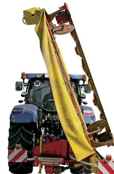
Nesený diskový žací stroj NOVACAT 352 V s pracovním záběrem 3,46 metru s vertikálním sklopením o 115° přes osu traktoru – rovnoměrné zatížení traktoru a dopravní výška pod 4 metry pro bezpečnost při dopravě.
