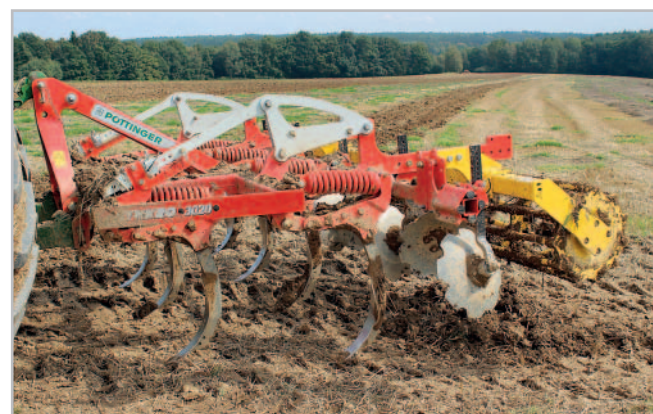
Dvouřadý radličkový kypřič má výhodu v nižším nároku na zvedací sílu i na tahový výkon, zvláště při hlubším zpracování půdy. Traktor John Deere 7530 Premium zvládal kypřič Synkro hladce a výsledkem byla dobře zpracovaná půda pro oschnutí s urovnaným povrchem pozemku
