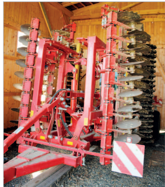
Talířový podmítač Terradisc 4000 T slouží nejenom k podmítkám, ale i pro přípravu půdy před setím. Těžký gumooceľový opěrný válec provádí účinnou konsolidaci půdy a drcení hrud
