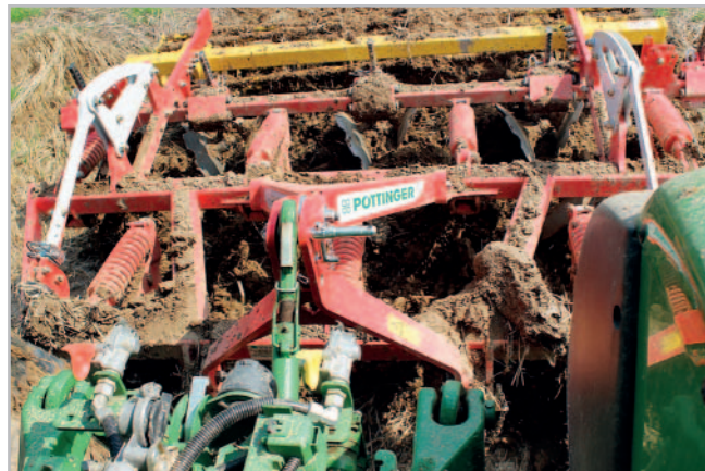
Při pohledu z místa spolujezdce je patrný volný prostor mezi jednotlivými radlicemi i mezi nosníky kypřiče. Urovnávací talíře spolu s robustním prutovým válcem se postaraly o urovnání pozemku a rozbití hrud
