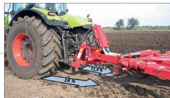
Obr. 10 – Vyrovnání prokluzu brázdového a záhonového kola. Tlak ve válci 11 MPa
