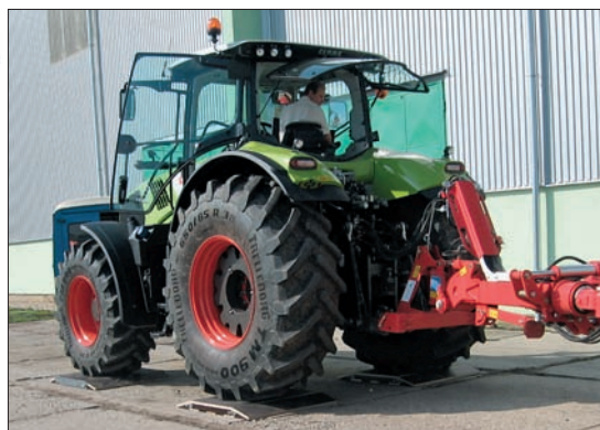
Obr. 6 – Měření zatížení jednotlivých kol traktoru, pluh Pöttinger 6.50 Plus NOVA v pracovní poloze pro orbu vlevo, tlak v trakčním válci 15 MPa
