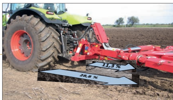
Obr. 9 – Rozdílný prokluz záhonového a brázdového kola. Trakční válec odpojen, tlak p = 0
