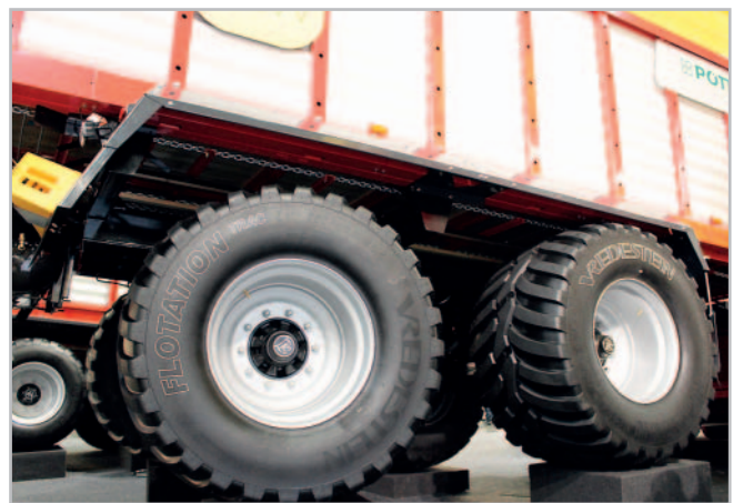
Firma Pöttinger používá u svých návěsů značkové nápravy BPW, k nimž nabízí řadu různých typů pneumatik. Široké nízkotlaké pneumatiky s rozměrem 750/45 R 26.5 se šetrným působením na půdu prezentoval návěs Torro 6510 L Combiline Foto Petr Beneš
