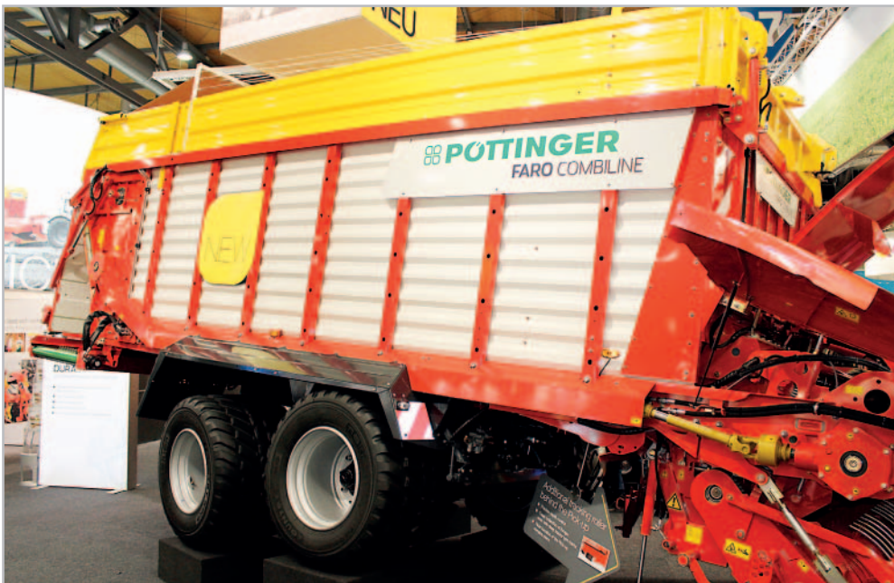
Návěs Faro 4010 D Combiline rozšiřuje řadu Faro o robustnější vozy pro univerzální využití jak při sběru píce z řádku, tak i pro odvoz od řezačky do místa uložení Foto Petr Beneš
