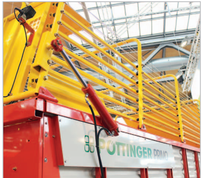
Primo 401 je návěs se širokou využitelností při senážování, sklizni zeleného krmení či sběru suché hmoty. Nástavbu na suchou hmotu je možné hydraulicky sklopit pro průjezd nízkými budovami Foto Petr Beneš
