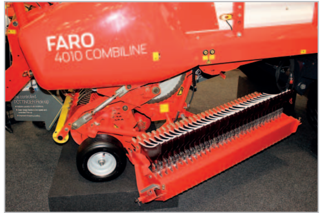
Návěs Faro 4010 Combiline může mít ve svém výkyvném nosníku maximálně 31 nožů, s nimiž dosáhne teoretické délky řezanky 45 mm Foto Petr Beneš
