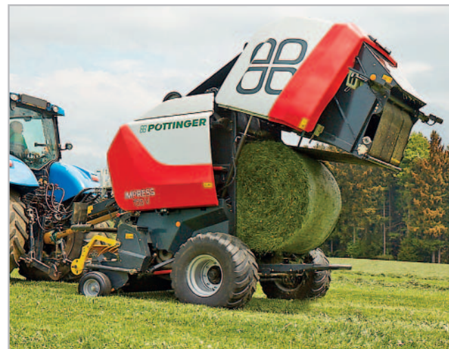
Variabilní lisovací komora modelu Impress 155 V dovoluje nastavení průměru balíků od 0,8 do 1,55 m
