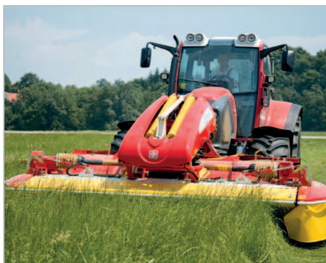
Čelně nesený žací stroj NovaCat 301 F v závěsu alpha-motion vynikl nejen plynulým kopírováním terénu i při vyšších jezdových rychlostech, ale též dlouhou životností noží, vyrobených z kvalitního materiálu Foto archiv
