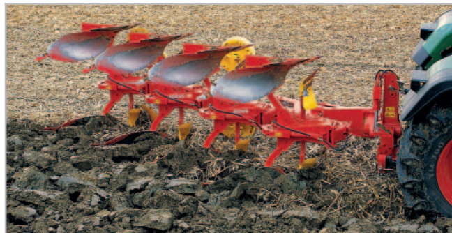
Nesený čtyřradličný pluh Servo 35 Nova svou kvalitou práce a čistým zaklápěním posklizňových zbytků splňuje nároky na orbu jakožto důležitou operaci v ekologickém režimu hospodaření Foto archiv
