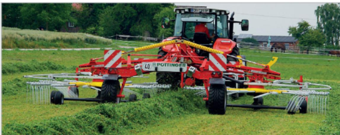
Středové shrnovače jsou charakteristické svou rovnoměrnou a vzdušnou tvorbou řádku. Z hlediska šířky, tvaru a rozložení ukládají středové shrnovače přesný řádek pro následné stroje. S pracovním záběrem od 7,7 do 8,4 m je Top 842 C koncipovaný pro dlouhodobé nasazení v náročných podmínkách
