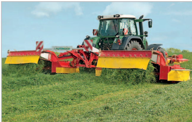
Žací kombinace NovaCat X8 ED pokosí ročně 1500–1800 hektarů při spotřebě pouhých 2,5 l/ha. Kvalitní kopírování terénu výrazně zlepšuje čistotu krmiva a prodlužuje životnost žacích nožů Foto archiv
