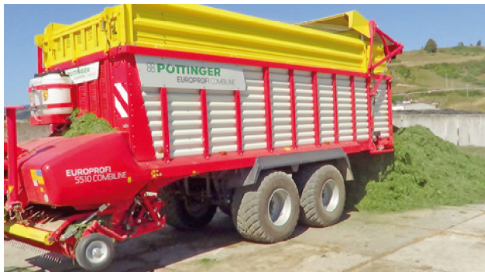
EUROPROFI 5510 combiline s objemom 55 metrov kubických pri vyprázdňovaní hmoty na žľabe.
