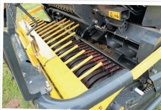
Rozhrnovací váleček o průměru 120 mm a urovňovací plech s masivními pruhy se starají o rovnoměrný přísun hmoty k rotoru
