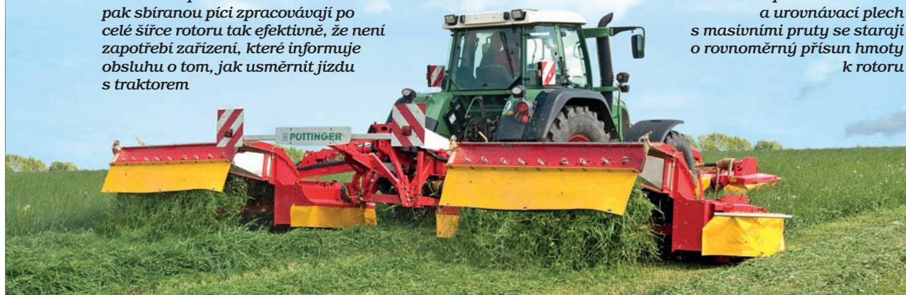
Žací kombinace NovaCat X8 ED pokosí ročně 1500–1800 hektarů při spotřebě pouhých 2,5 l/ha. Kvalitní kopírování terénu výrazně zlepšuje čistotu krmiva a prodlužuje životnost žacích nožů. Nože jsou uchyceny na oválném žacím disku s plochým tvarem, vyrobeným z kalené jemnozrnné oceli
