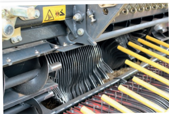
Dva šnekové dopravníky soustřeďují píci ze stran do prostoru rotoru. Hvězdice pak sbíranou píci zpracovávají po celé šířce rotoru tak efektivně, že není zapotřebí zařízení, které informuje obsluhu o tom, jak usměrnit jízdu s traktorem
