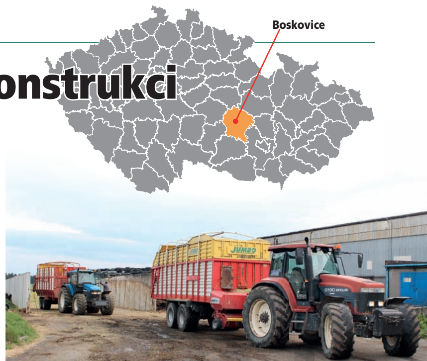
ZD Skály, družstvo využívá dobře propracované výkonné technologie sklizně pícnin. Jejich nedílnou součástí je i dvojice senážních návěsů firmy Pöttinger - Jumbo 7200 L (v popředí) a Europrofi 3 L. Druhý z vozů pracuje nepřetržitě již od roku 2000
