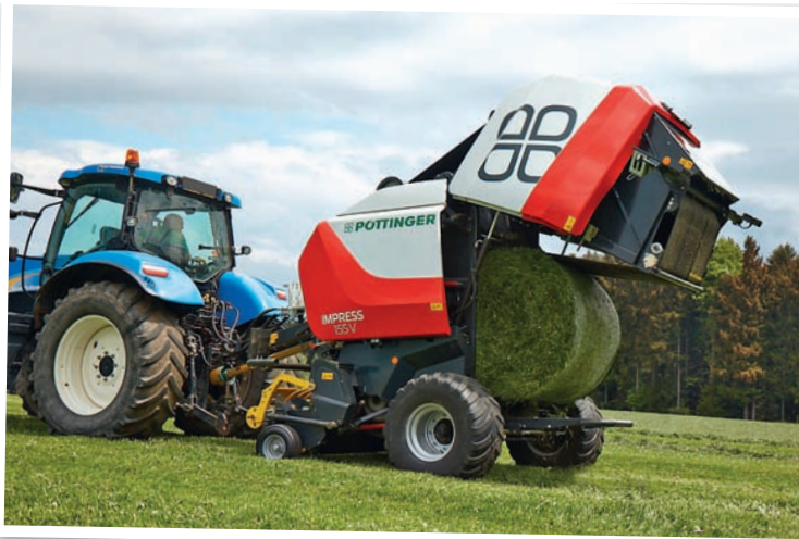
Variabilní lisovací komora modelu Impress 155 V dovoluje nastavení průměru balíků od 0,8 do 1,55 m
