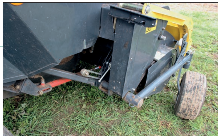
Sběrač o šířce 2,3 m má velmi dobré kopírování terénu (i při zatáčení) díky zavěšení pomocí ramen a osazení nastavitelnými vodícími kolečky. Ty snímají terén přesně v místech kontaktu prstů se zemí
