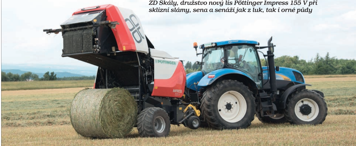
Zkušenosti z nasazení v podniku ZD Skály, družstvo potvrdily vyšší úroveň slisovanosti než u předchozí generace lisů Pöttinger. Balíky mají pěkný pravidelný tvar
