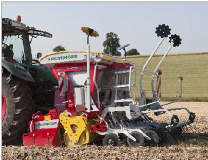
Pro dávkování kukuřice vyvinula firma Pöttinger vlastní dávkovací ústrojí s označením Precision Combi Seeding (PCS)
