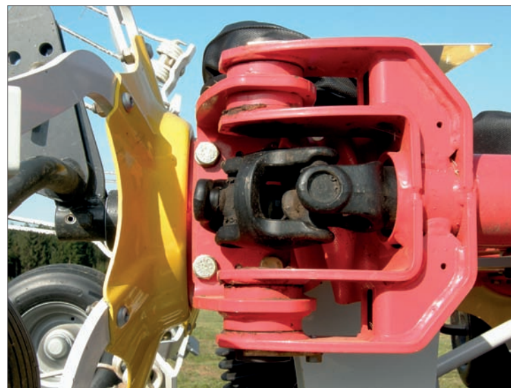
Také širokozáběrové tažené obrabeče HIT T mají pohyblivě spojené rotory, protože kvalitní kopírování půdy a šetrná práce s materiálem jsou u firmy Pöttinger samozřejmostí. Díky kloubovým převodům se rotory mohou přizpůsobovat nerovnostem povrchu
