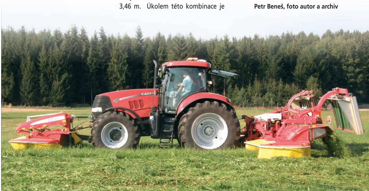
Jednoduchým povelům z kabiny mohou být oba pásy systému Collector zvednuty mimo záběr, pokud je třeba například určité části pozemku posekat s odložením píce na široko
