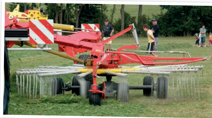
Rotory shrnovačů Pöttinger jsou osazeny rovnými prsty bez velkého zalomení. Shrnování píce přímo pod hrabíci znamená i menší zatížení prstu shrnovaným materiálem a možnost pracovat těsně nad strništěm s omezením příměsí
