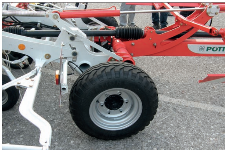
Kulísový mechanismus Liftmatic Plus umožňuje vodorovné zvedání a spuštění rotorů obrabeče HIT 10.11 T, díky kterému se stroj otáčí na souvratích bez kontaktu s půdou. Zdvih rotorů při otáčení činí až 90 cm
