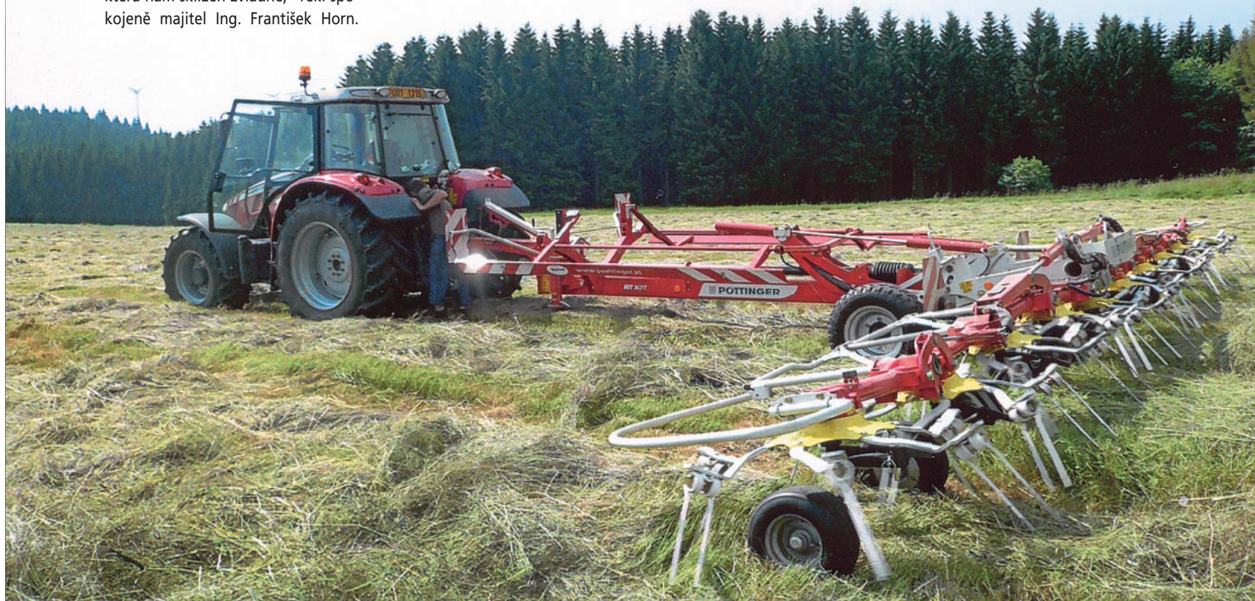
V agregaci s traktorem o výkonu 80 k lze s obrabečem HIT 10.11 T firmy Pöttinger obrátit píci na výměře 60–70 hektarů za den. I při práci s dlouhou píci nedochází k jejímu zachytávání na rotory nebo ramena
