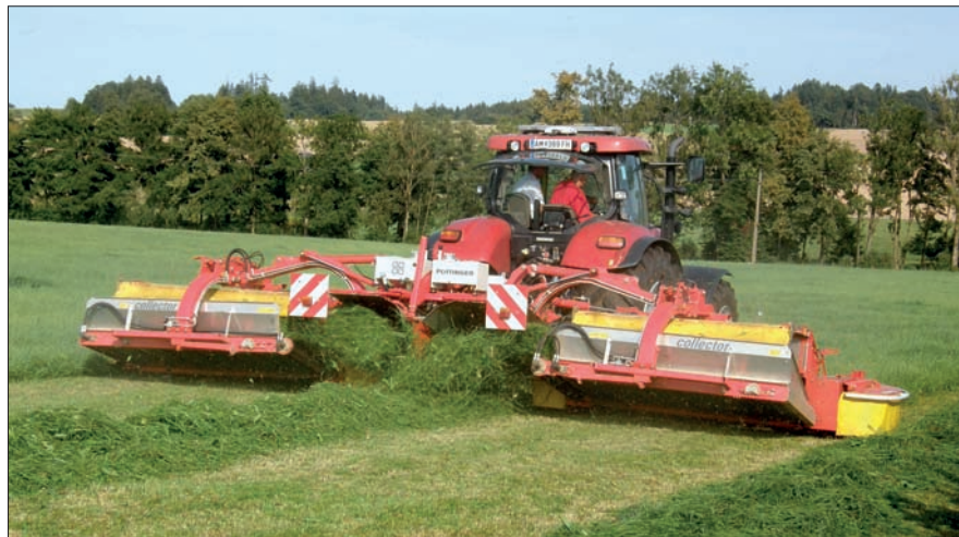
Dopravníkový systém Collector, využívaný při sklizni luk na senáž na pozemcích farmy EKOCHOV CMN, uspoří přejezdy dalších dvou traktorů, a zároveň snižuje znečištění píce a odol cenných částí rostlin
