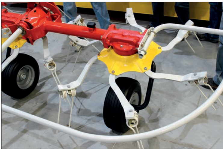
Tažené obrabeče HIT T využívají rotory se šesti rameny. Píce je po otočení odkládána rovnoměrně na pokos díky tvarování ramen prstů a jejich přesnému uchycení do profilů lisovaných rotorů
