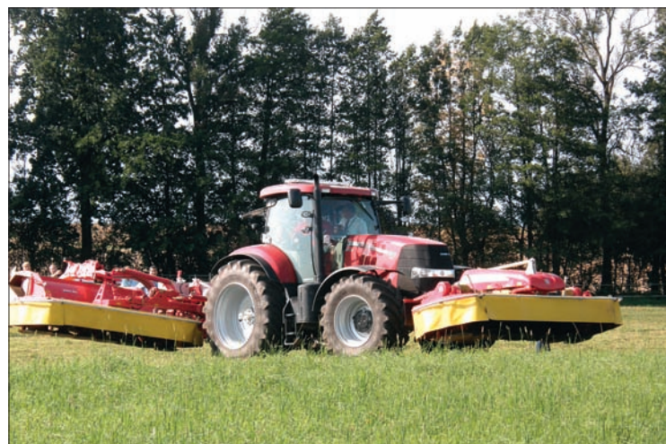
Jednou z výhod neseného uspořádání žacích kombinací Pöttinger oproti agregacím s taženými stroji je obratnost soupravy a snadná manévrovatelnost i na členitých pozemcích
