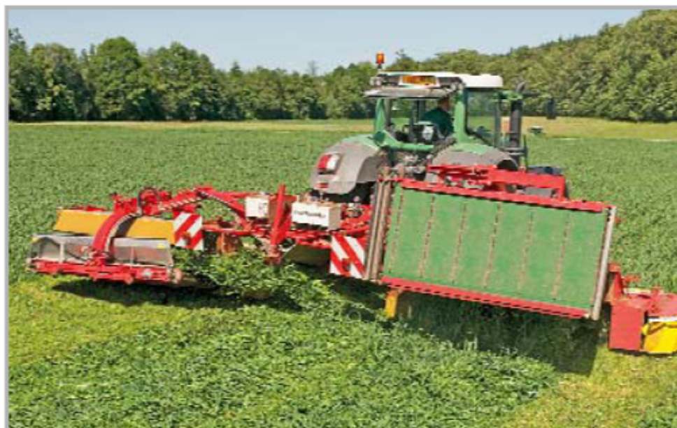
Charakteristickým znakem žacích kombinací je stavebníková konstrukce – zařízení pro úpravu pokosu nebo shazovací pásy jsou velmi snadno demontovatelné
