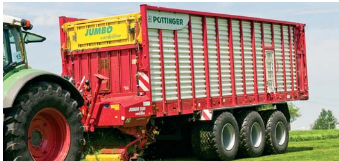
Senážny voz JUMBO 10010 Combiline s nápravou „TRIDEM“ a celkovou hmotnosťou 31 000 kg.
