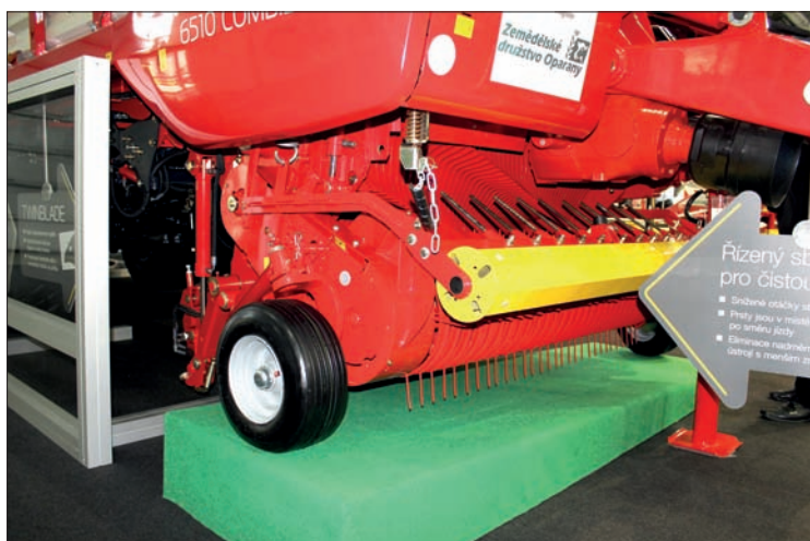
Výkvný sběrač se šesti řadami prstů zajišťuje sběr hmoty i v obtížných podmínkách a na výnosných rádcích. Prsty plnicího rotoru mohou hmotu odebírat přímo z prostoru sběrače díky tomu, že tento úsek prošel optimalizací za účelem zvýšení produktivity
