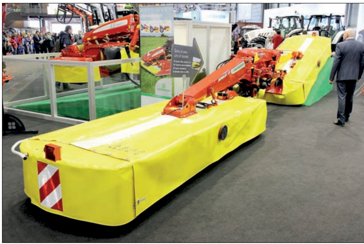
Žací kombinace NovaCat S10 je osazena celkem 16 žacími disky a nabízí výkonnost zhruba 11 hektarů za hodinu s traktorem o výkonu pouze 130 k. Díky osvědčenému středovému zavěšení je možný příčný výkyv žacích strojů na úrovni až 22° nahoru či dolu
