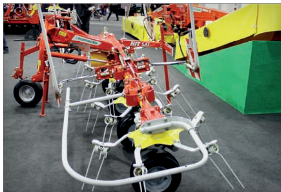
Nejmenší šestirotorový obrabeč HIT 6.61 má pracovní záběr 5,75 m. Nově sortiment doplňuje velký model HIT 6.80 T se záběrem 7,85 m a přidavným podvozkem, který sleduje stopu traktoru
