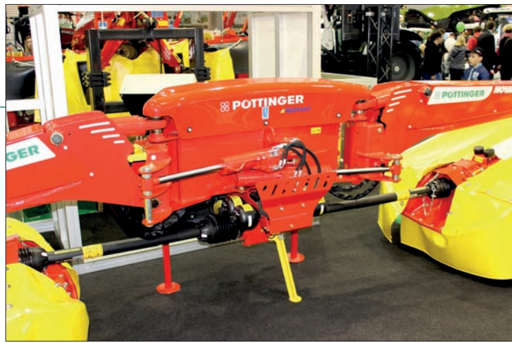
Součástí závěsu u kombinací S10 a S12 je mechanismus pro přestavení žacích jednotek. Zároveň slouží i jako nájezdová pojistka a dovoluje sklopení do transportní polohy se šířkou pouze 2,2 m. Standardem je plynule nastavitelné hydraulické odlehčení žacích strojů
