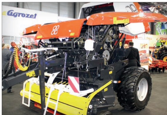
Pevná komora lisu Impress 125 F je tvořena osmnácti válci, poháněnými řetězem. Hmota je do komory dopravována tangenciálně pod optimálním úhlem díky technologii Liftup
