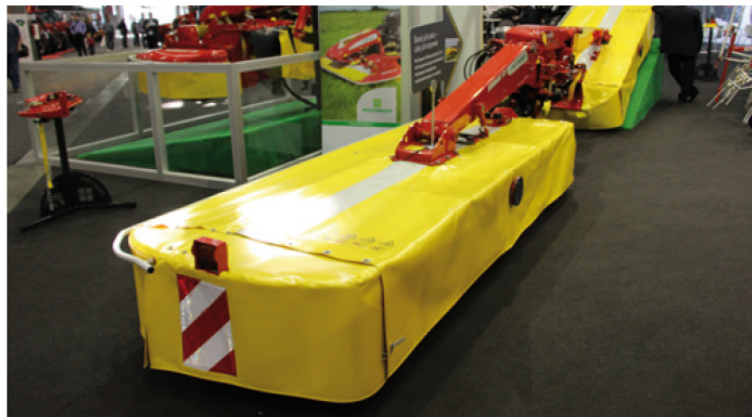
S pracovným záberom desiatich metrov bola prezentovaná disková žacia kombinácia Pöttinger Novacat S 10 s čelnou kosou Novacat 301 Alpha Motion.
