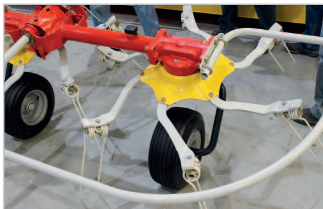
Tažený obrabeč Hit T využívá rotory se šesti rameny. Píce je po otočení odkládána rovnoměrně na pokos díky tvarování ramen prstů a jejich přesnému uchycení do profilů lisovaných rotorů. Foto Petr Beneš
