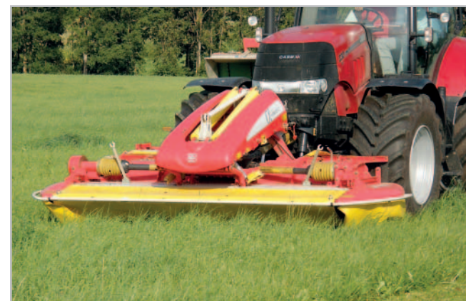
Čelně nesený žací stroj NovaCat ED si poradí s nerovnostmi terénu i za jízdy vyšší rychlostí díky svému originálnímu zavěšení alpha-motion. Závěs kopíruje terén spolu s žací lištou a přítlak je udržován na konstantní úrovni. Foto Petr Beneš
