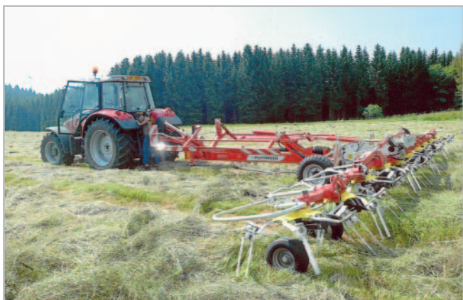
V agregaci s traktorem o výkonu 80 k lze s obrabečem Hit 10.11 T firmy Pöttinger obrátit píci na výměře 60 až 70 hektarů za den. Ani při práci s dlouhou píci nedochází k jejímu zachytávání na rotory nebo ramena. Foto Petr Beneš
