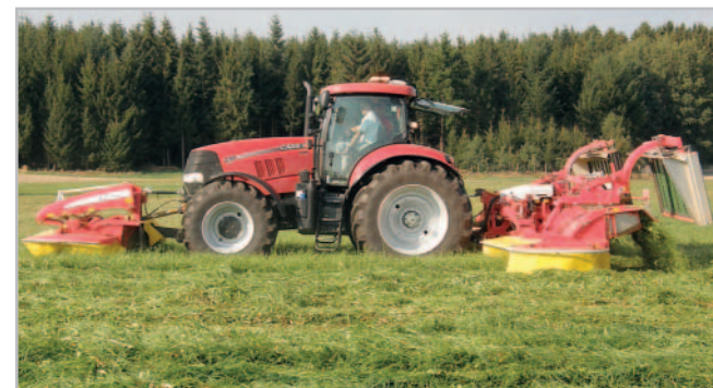
Jednoduchým povelům z kabiny mohou být oba pásy systému Collector zvednuty mimo záběr, pokud je třeba například určitě části pozemku posekat s odložením píce naširoko. Foto Petr Beneš
