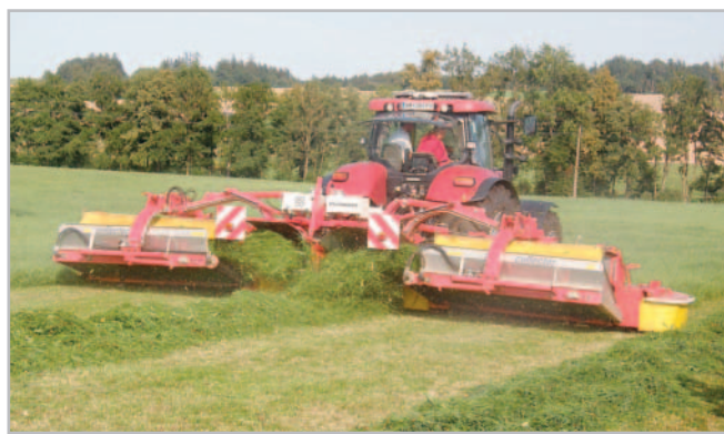
Dopravníkový systém Collector, využívaný při sklizni luk na senáž na pozemcích farmy EKOCHOV CMN, uspoří přejezdy dalších dvou traktorů, a zároveň snižuje znečištění píce a odol cenných částí rostlin. Foto Petr Beneš
