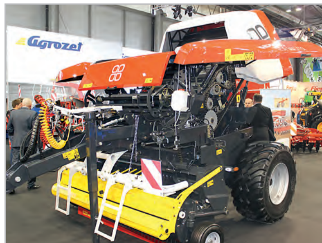
Pevná komora lisu Impress 125 F je tvořena osmnácti válci poháněnými řetězem. Hmota je do komory dopravována tangenciálně pod optimálním úhlem díky technologii Liftup Foto Petr Beneš
