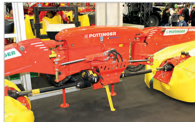
Součástí závěsu u kombinací S10 a S12 je mechanismus pro přestavení žacích jednotek. Zároveň slouží i jako nájezdová pojistka a dovoluje sklopení do transportní polohy se šířkou pouze 2,2 m. Standardem je plynule nastavitelné hydraulické odlehčení žacích strojů Foto Petr Beneš
