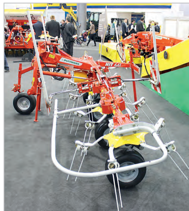
Nejmenší šestirotorový obrabeč Hit 6.61 má pracovní záběr 5,75 m. Nově sortiment doplňuje velký model Hit 6.80 T se záběrem 7,85 m a přídavným podvozkem Foto Petr Beneš
