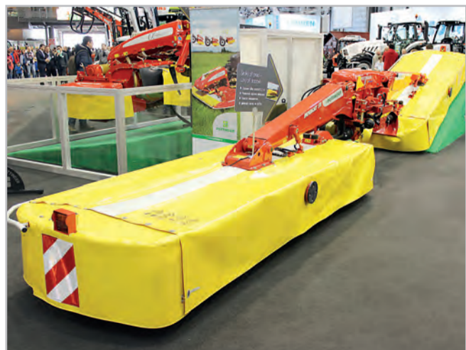
Žací kombinace NovaCat S10 je osazena celkem 16 žacími disky a nabízí výkonnost zhruba jedenáct hektarů za hodinu s traktorem o výkonu pouze 130 k. Díky osvědčenému středovému zavěšení je možný příčný výkvy žacích strojů na úrovni až 22° nahoru či dolu Foto Petr Beneš
