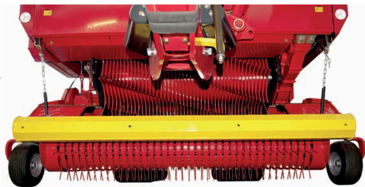
Sběrač Extra-Large se šířkou celých 2360 mm se v praxi ukázal jako užitečná výbava pro usnadnění sběru píce z řádku, protože je zapotřebí podstatně méně manévrovat s vozem
