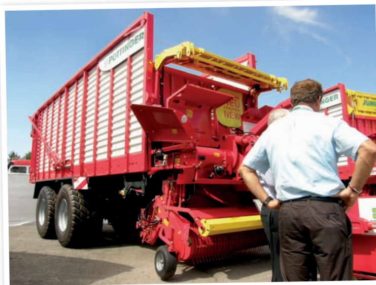
Kombinované návěsy Jumbo Combiline jsou předmětem dialogu a středem zájmu zemědělců díky své široké úrovni výbavy a možnému využití pro sběr píce z řádku, odvoz hmoty od řezačky i sklizeň suché hmoty po doplnění stropními profily. Mohou být vybaveny například podvozkem Tridem, rozšířeným sběračem či zařízením pro zakrytí stropu
