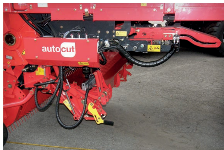
Automatické broušící zařízení Autocut výrazně zjednodušuje broušení nožů na návěsu Jumbo 10010 L Combiline
