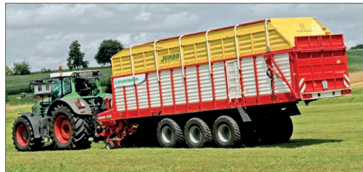
Jakmile je třeba sklízet zavادلou píci z velkých výměr, nastupuje senážní návěs Jumbo 10010 L. Na jedno naložení sesbírá tento vůz píci ze čtyř až pěti hektarů louky
