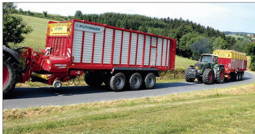
Zemědělské družstvo Nové Město na Moravě využívá návěsy Pöttinger Jumbo 10010 L a Jumbo 10010 L Combiline. Na podvozcích Tridem plynule sledují traktor i na nepravidelných řádcích, při otáčení a při vjíždění a vyjíždění z pozemků
