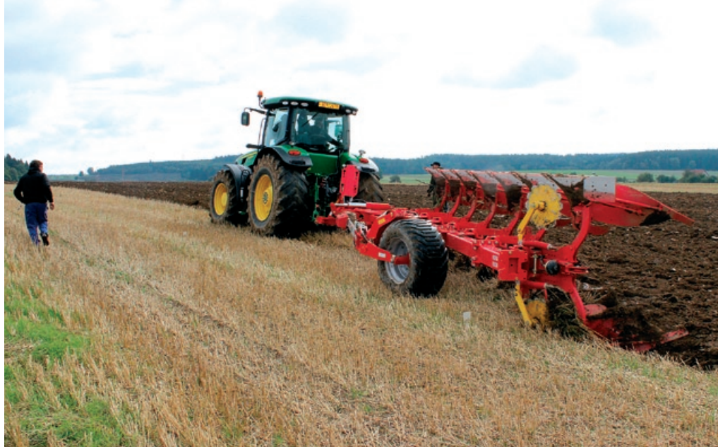
Orební souprava traktor John Deere 8295 R se sedmiradličním návěsným pluhem Pöttinger SERVO 6.50 NOVA. Testování proběhlo v podniku Zemspol, a. s., Sloup v říjnu 2013.
