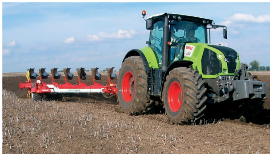
Orební souprava traktoru Claas 850 Axion s osmiradličním návěsným pluhem Pöttinger 6.50 PLUS NOVA. Testování proběhlo v Jiřicích v září 2014.
