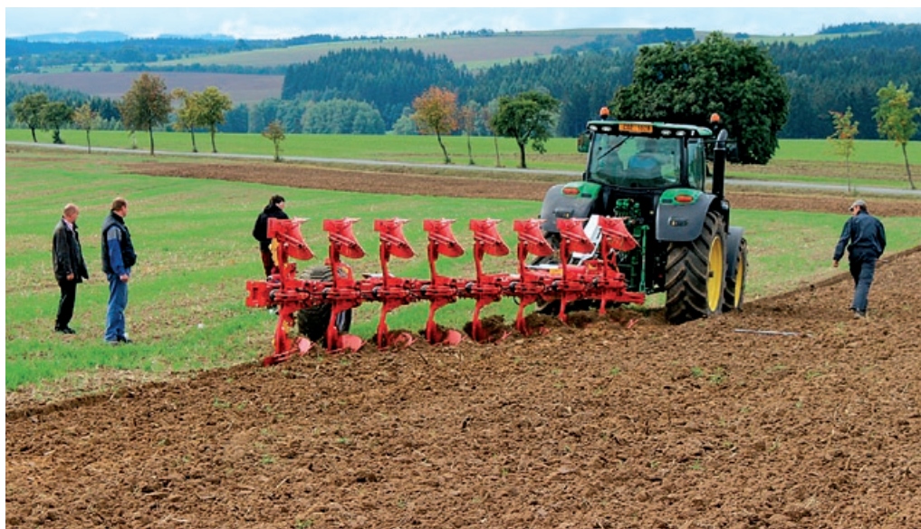
Souprava traktoru John Deere 6215 R s osmiradličním návěsným pluhem Pöttinger SERVO 6.50 PLUS NOVA. Testování se uskutečnilo v ZD Nové Město na Moravě v září 2015.
