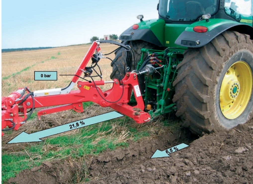
Při plovoucí poloze rozvaděče vnějšího okruhu hydrauliky je v hydraulickém válci prakticky nulový tlak. Hydraulický válec nepřenáší zatížení z pluhu na traktor. U záhonového kola byl naměřen průměrný prokluz 21,8 % a brzdového kola 6,5 %.
