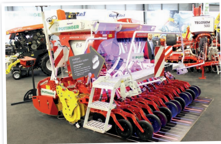
Pneumatický secí stroj Aerosem 3002 ADD má nové možnosti ukládání osiva do řádků s různou roztečí, což bylo v expozici také zobrazeno vizuálně. Na rodinném zemědělském podniku dovoluje snížení pořizovacích nákladů i nákladů na osivo
