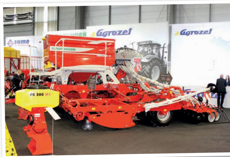
Pneumatické secí stroje Terrasem jsou koncipovány jako univerzální k výsevu všech druhů osiv včetně trav. Díky své třídičné konstrukci se snadno přizpůsobí povrchu půdy. K inovacím patří změněné uložení ventilátoru a nové možnosti v systému inteligentního ovládacího terminálu Artis
