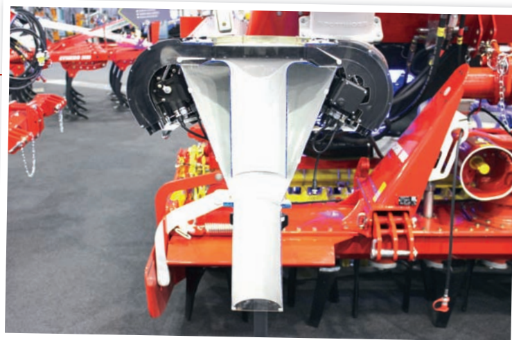
Inteligentní distribuční hlavice (výbava na přání pro secí stroje Aerosem 3002 ADD) má dálkově ovládané vývoje a dovoluje tak svému uživateli zvolit si libovolnou rozteč kolejových meziřádků či jejich šířku
