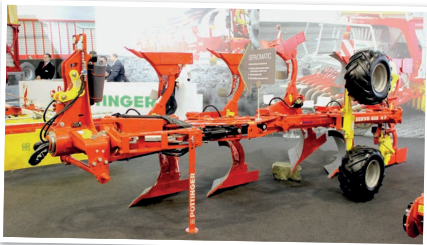
Nesené pluhů Servo 45 S jsou koncipovány k orbě za těžkých podmínek v agregaci s traktory o výkonu až 270 k. Vyznačují se stabilitou, spolehlivostí a robustností. Vystavený pluh byl vybaven nonstop jištěním těles Nova, hydraulicky nastavitelným záběrem Servo Plus a systémem Traction Control pro přídavné dotížení traktoru
