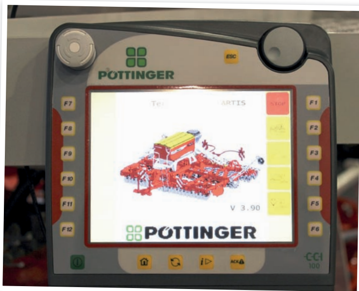
Ovládání secího stroje Terrasem na ISOBUS terminálu CCI 100 nabízí širší rozsah funkcí, než dosavadní provedení Powercontrol, a to včetně řešení precizního zemědělství. Například je možné variabilně ovládat výsevku v rámci systému Seed Complete
