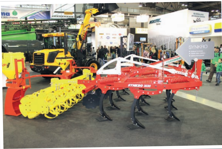
Radličkové kypřiče Synkro 1030 mají různé možnosti nastavení svého závěsu pro snadnou agregaci s traktory různých výrobců, a stejně tak i pohodlně přístupné nastavení pracovní hloubky prostřednictvím dorazů
