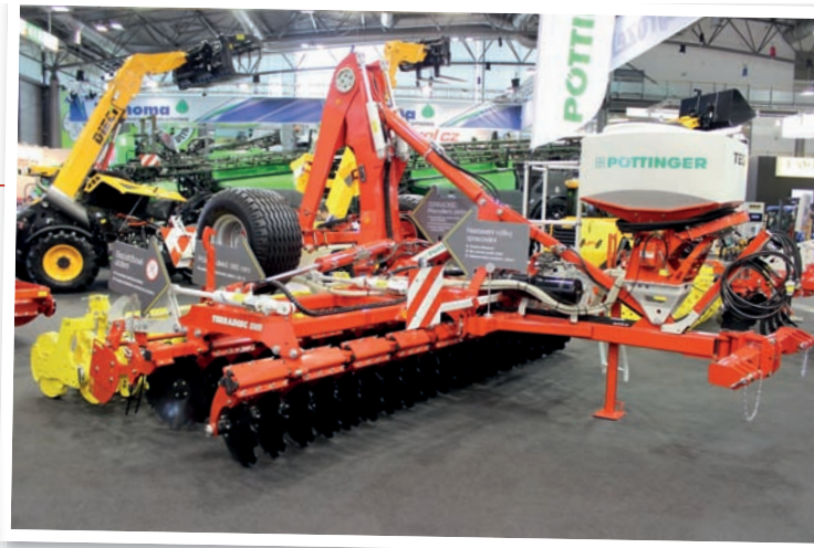
Terradisc 5001 pracuje s velkými talíři o průměru 580 mm a může být využíván ke zpracování půdy až do hloubky 18 cm, k podmínkám, přípravě půdy před setím či k zakládání porostů meziplodin nebo zeleného hnojení
