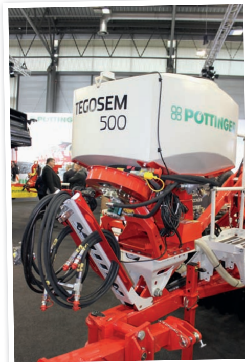
Větší verze secího stroje Tegosem má zásobník osiva o objemu 5000 l a u návěsných půdozpracujících strojů Terrasem a Synkro je připojena na oji
