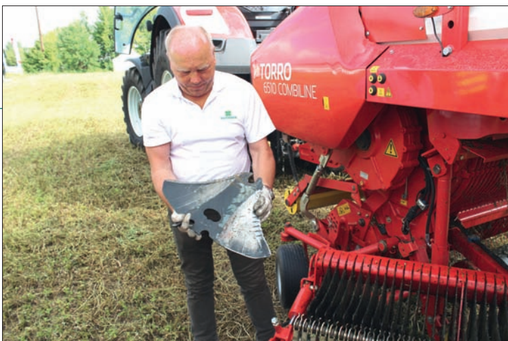
Zástupce firmy Pöttinger představil nože Twinblade, dodávané k návěsům Torro Combiline na přání. Jsou opatřeny vlnovým výbrusem na obou stranách, takže po opotřebení ostří je možné je pouze otočit a pokračovat v práci. Tím se interval výměny nožů prodlužuje na dvojnásobek
