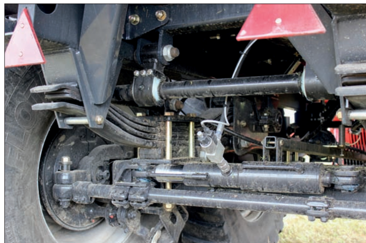
Návěs Torro 6510 Combiline představil zajímavou variantu tandemového podvozku. Náprava se sdruženým uchycením je vlastně tažená a díky tomu snadno překonává terénní nerovnosti a překážky
