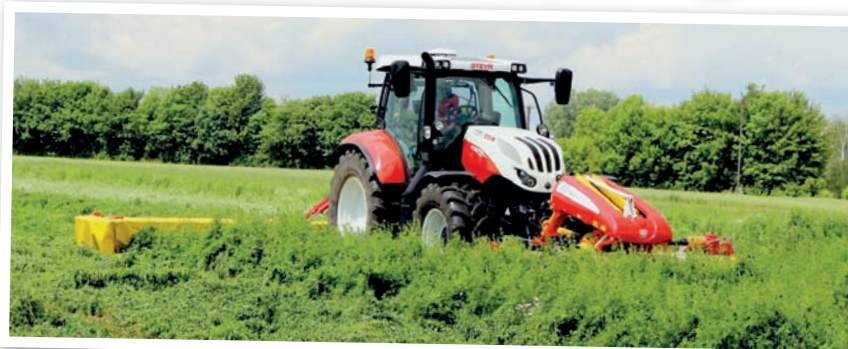
V případě zvýšených nároků na odběr výkonu umí motor traktoru Steyr Profi poskytnout další navýšení výkonu díky systému PowerPlus. Je aktivní při zapnutém a zatíženém vývodovém hřídeli a současně za jízdy rychlostí alespoň 200 m/h či v dopravě
