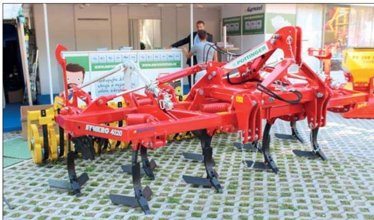
Radličkový kypřič Synkro 4020 K Nova představuje univerzální stroj pro zpracování půdy do hloubky až 30 cm. Může být osazen různými druhy radliček
