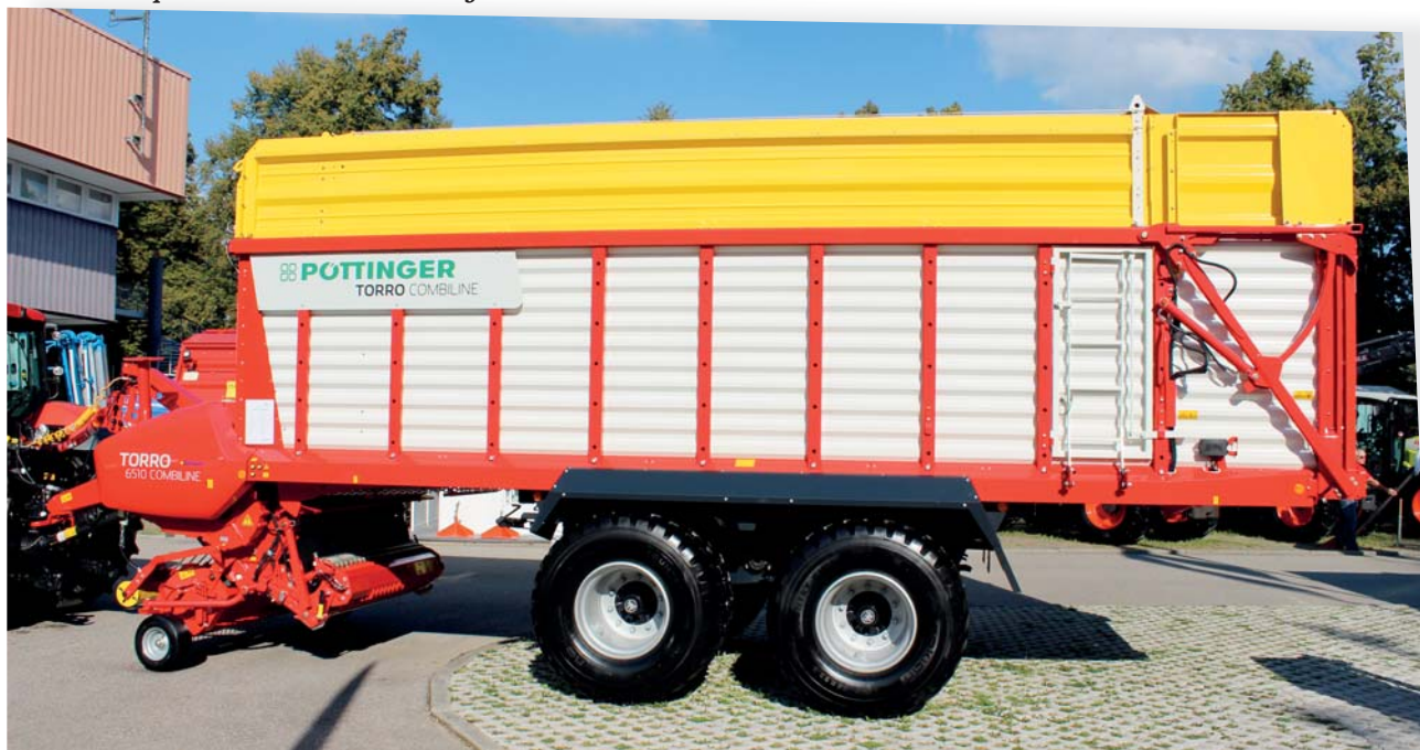
Modely vozů Torro Combine s novým designem jsou zesílené a ve svém řezacím ústrojí disponují 45 noži v rozteči 34 mm. Na přání mohou být nože oboustranné a návěsy lze vybavit systémem Autocut
