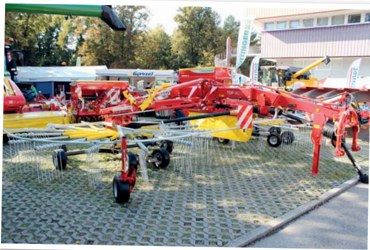
Oblíbenou skupinu strojů firmy Pöttinger posiluje nový model dvourotorového shrnovače TOP 962C. Se záběrem až 9,6 m je praktickou alternativou největším modelům se čtveřicí rotorů
