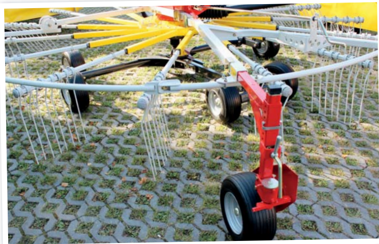
Tandemová náprava rotorů je doplněna o přední zdvojené snímací kolečko, které funguje ve spolupráci s předsunutým snímacím kolečkem
