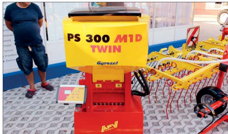
Do svého kovového dvoudílného zásobníku s kapacitou 300 l může PS 300 M1D TWIN firmy APV pojmout dva druhy osiva nebo osivo a hnojivo, což dovoluje účelně slučovat pracovní operace
