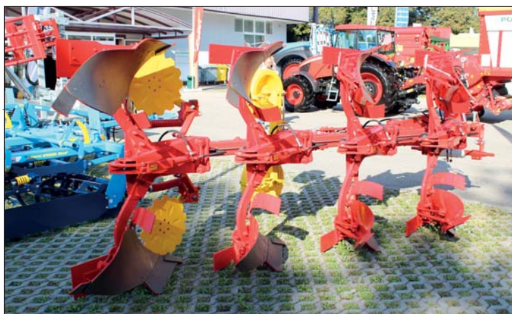
Nesený pluh Servo 35 S Nova je postavený na rámu s profilem 120 x 120 mm. Systém hydropneumatického jištění Servo Nova dovoluje výškový výkyv těles až 40 cm a stranový výkyv až 20 cm
