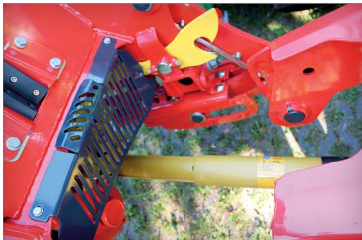
S konstrukčními změnami v převodovce souvisí i přemístění přetěžovací spojky, která se nově nachází na kraji závěsu. Po odejmutí krytu je zvenčí snadno přístupná
