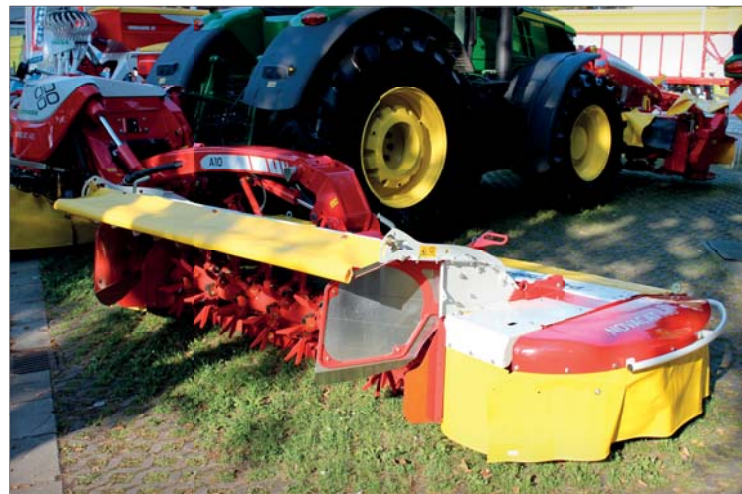
Prezentovaný stroj NovaCat A10 v expozici společnosti Agrozet České Budějovice byl vybaven prstovým lamačem ED, ale další možnosti jsou i mačkáci válce RCB anebo provoz jen se shazovacími plechy. Stranové kryty jsou standardně sklápěny hydraulicky
