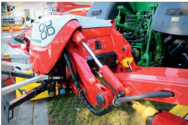
Pod novým krytem závěsu se skrývá řada inovací. Nosníky žacích strojů jsou uchyceny pomocí kloubů a udržovány ve své poloze hydraulickým předpětím pomocí trojice ramen
