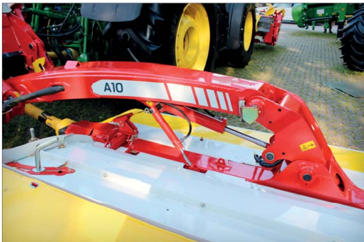
Prostřednictvím silnější ze dvou pístnic je realizována možnost plynule měnit pracovní záběr žací kombinace. Menší pístnice pak slouží k uzamčení výšky žacích strojů v průběhu otáčení na souvratích či přejezdů
