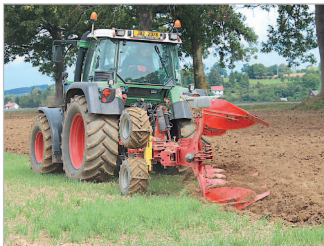
Na hlinitopísčitých půdách v nadmořské výšce 755 až 790 metrů odvádí pluh Pöttinger velmi dobrou práci co se týká stejnoměrné hřebení půdy bez známek řádkování a drobení ornice
