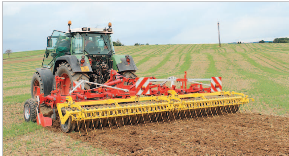
Synkro 6020 K Nova lze agregovat i v pracovním záběru 6 m jako nesený stroj. Přitom nemá vysoké nároky na tahový výkon traktoru, jemuž stačí výkon motoru 240 k i pro středně hluboké kypření půdy v kopcích
