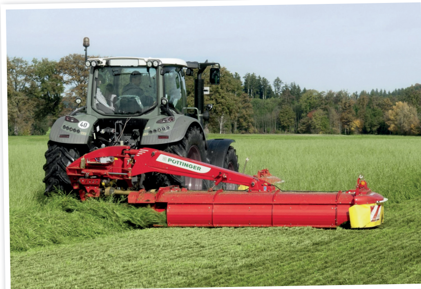
Žací stroj Pöttinger NovaCat 352 CF za sebou zanechává čistý pozemek se zdvojeným řádkem, na němž je uložena píce bez ztrát a bez znečištění
