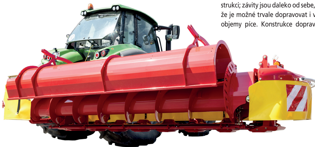
Jednoduchým zvednutím zadního krytu dopravníku je možné docílit toho, že píce je odkládána na široko. Po sklopení krytu posouvá dopravník veškerou hmotu ke středu soupravy, přičemž díky od sebe vzdáleným závitům má vysokou průchodnost
