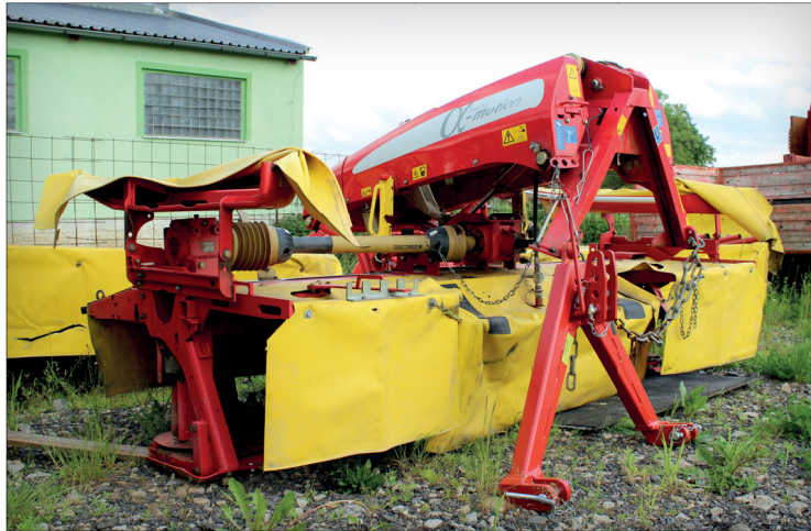
Čelně nesený žací stroj NovaCat 301 F alpha-motion není vybaven kondicionérem s V prsty. Při sklizni hrachu či jetelovin sklízí hmotu bez ztrát odrolem a na vytvořený řádek mezi koly traktoru ukládá další píci stejně šetrně nový, vzadu nesený žací stroj NovaCat 352 CF
