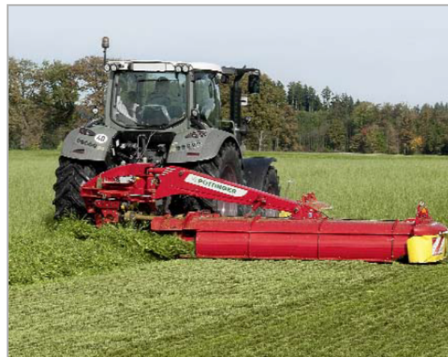
Žací stroj Novacat 352 CF je díky svému šetrnému působení na píce a bezztrátovosti sklizně vhodný nejen pro louky, ale i pro sklizeň hrachu, jetelovin či ozimých obilnin na GPS. Dopravník také eliminuje riziko případného znečištění píce při shrnování
