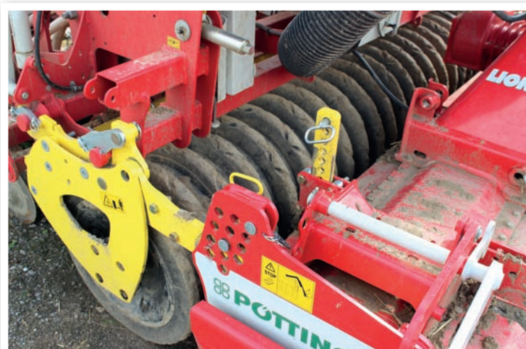
Gumový opěrný válec vykazuje vynikající účinnost na všech druzích půd, a to i za mokra. Je odolný vůči zalepování i kamenům, což je při práci v neznámých podmínkách výhodou
