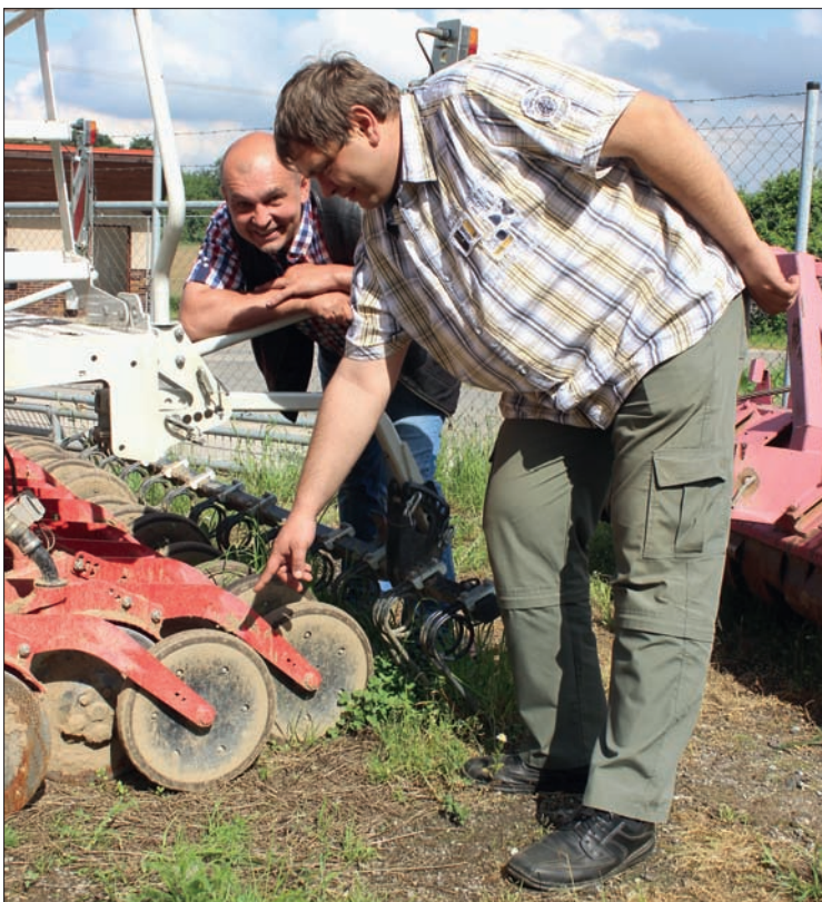
„Dvoukotoučové secí botky s kopírovacími kolečky dokážou dostat osivo do zorané i do jen mělce nakypřené půdy v nastavené hloubce zcela spolehlivě. Osvědčují se i při přisevech travních porostů,“ sdělil své zkušenosti Petr Miksa (upravo) zástupci firmy Pöttinger pro Českou a Slovenskou republiku Ing. Zdeňkovi Bílému
