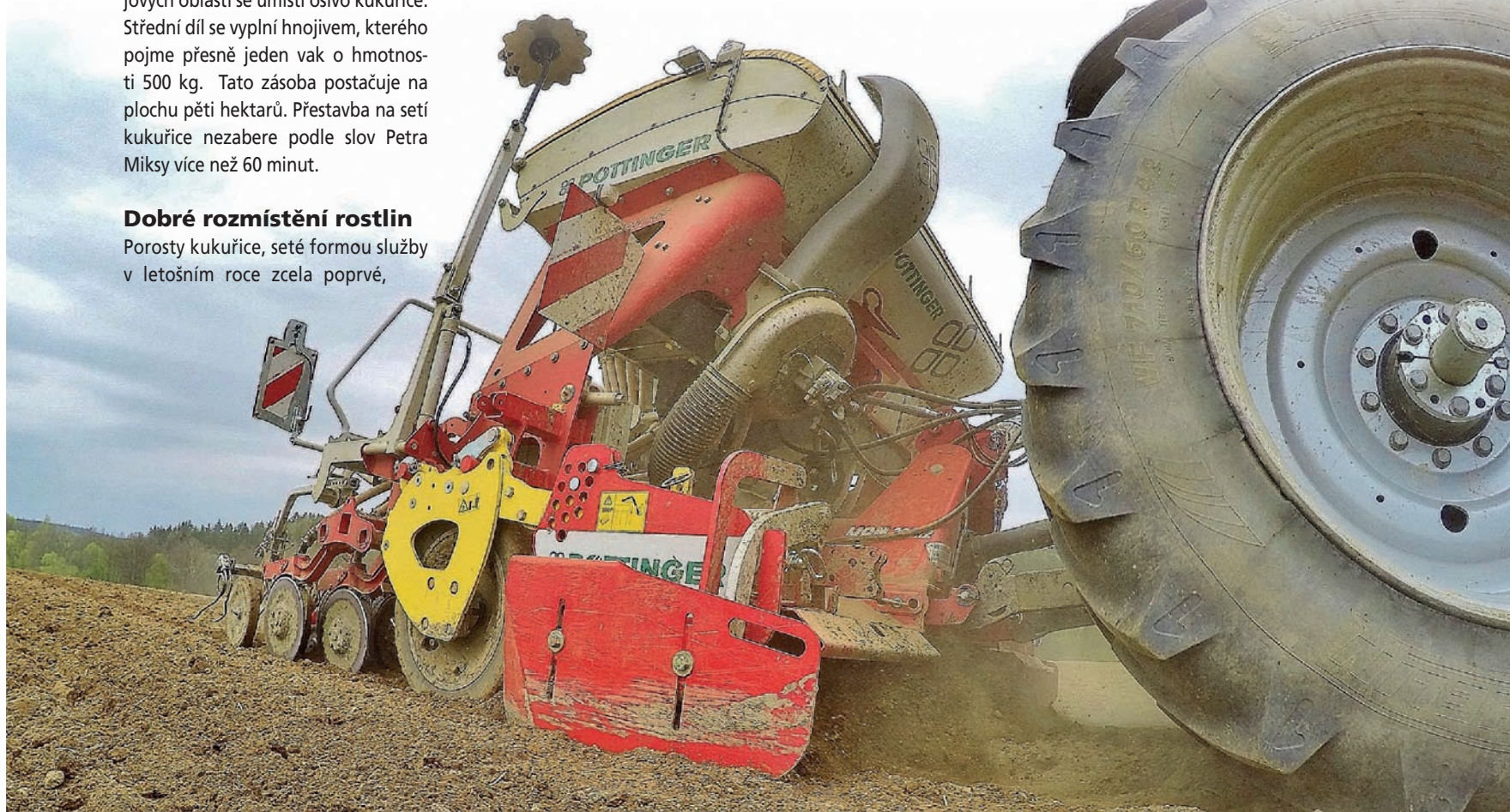
S pneumatickým secím strojem Aerosem 3002 ADD firmy Pöttinger bylo možné za den zasít patnáct hektarů kukuřice a dvacet hektarů obilnin
