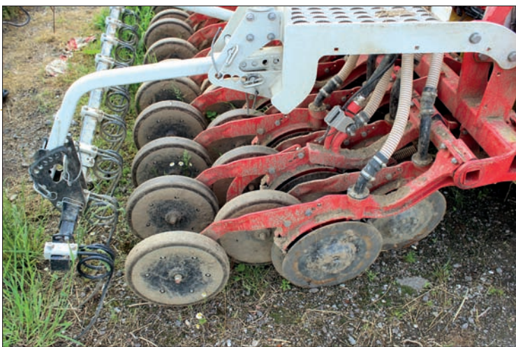
Secí botky pro výsev kukuřice jsou vybaveny optickým senzorem, který kontroluje procházející zrna. V případě odchylky výše upozornění
