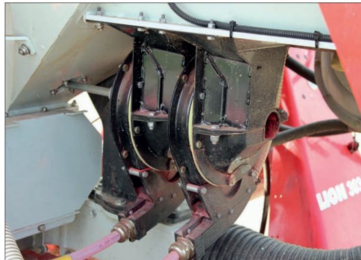
Jednotky PCS využívají zajímavý princip rotoru s přidržovacími miskami, které nabírají zrna kukuřice, a elevátoru, jenž jednotlivá zrnka přebírá od rotoru a dopravuje do proudu vzduchu k botce
