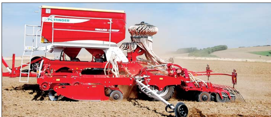
Za 11 hodinovú pracovnú smenu zaseje a prihnojí Terrasem C6 Fertilizer 45 až 60 ha.
