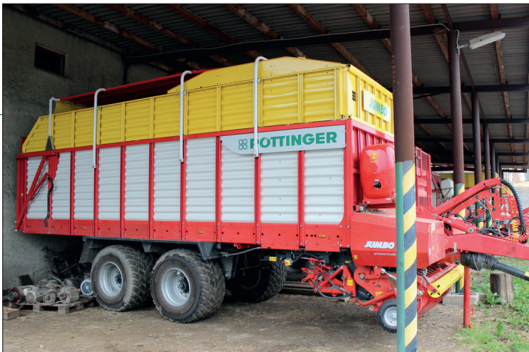
Senážní návěs Pöttinger Jumbo 6610 L se v praxi ukázal jako stroj s nízkou energetickou náročností nejen na tahový výkon (díky změně v podvozku), ale i na pohon vývodovým hřídelem (díky inovacím v plnicím systému). Vůz sklízí i příkré svahy bez sebemenšího zaváhání
