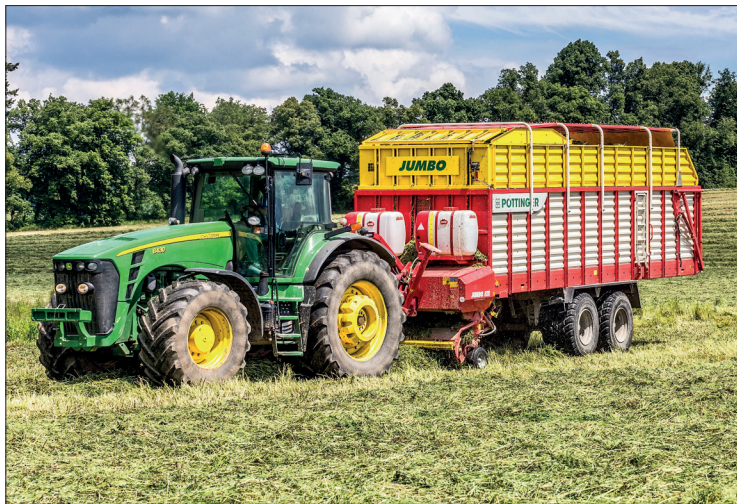
Technologie sklizně pomocí senážního návěsu vedla k výraznému zjednodušení organizace práce a ke zmenšení nákladů díky snížení spotřeby paliva i počtu pracovních sil
