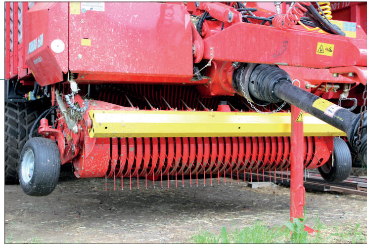
Výkonný sběrač návěsu Jumbo 6610 L je osazen hustě uspořádanými prsty v osmi řadách. Tradičně kvalitní kopírování povrchu je zajištěno díky možnosti příčného výkyvu a nastavování opěrných kol. Pohon sběrače je vypínán automaticky
