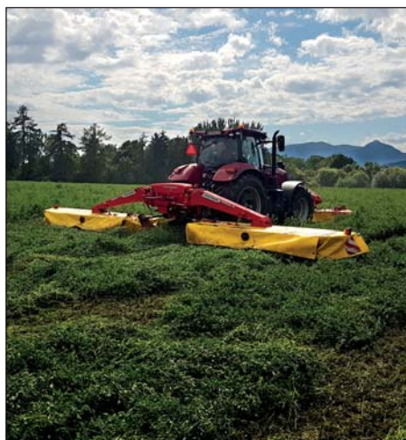
Žacia kombinácia Pöttinger S10 s pracovným záberom 10 m.
