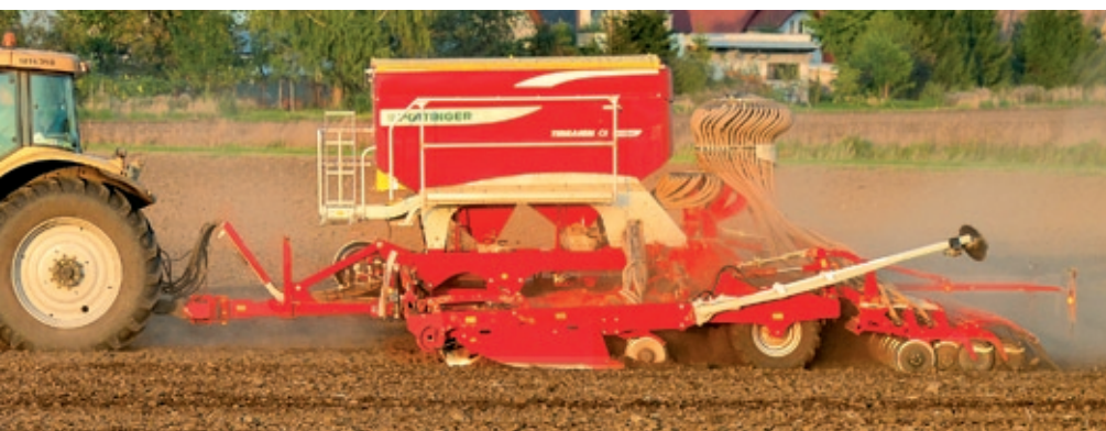
Šestmetrový univerzálny sejací stroj TERRASEM C6 FERTILIZER s príhnojovaním umožňuje súčasné dávkovanie a ukladanie osiva i štartovacej dávky umelého hnojiva.
