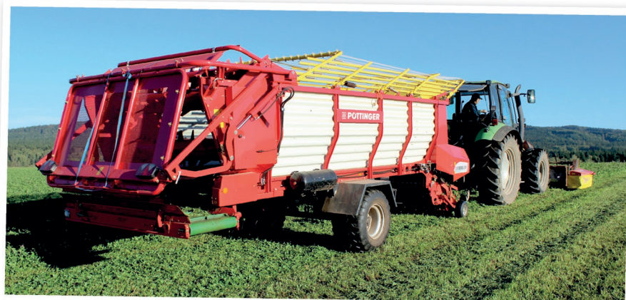
Spokojenost s kvalitou řezanky u návěsů Jumbo vedla Jiřího Stupku k pořízení samosběracího návěsu Euroboss 330 DH. Čerstvou píci tento vůz zpracovává svým řezacím ústrojem s patnácti noži v jedné řadě a do žlabu dopraví pomocí zakládacího dopravníku
