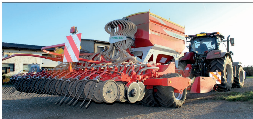
Velký objem zásobníku osiva, vyšší pracovní rychlost a tím i vysoká výkonnost při zakládání porostů jsou hlavní výhody univerzálního secího stroje Terrasem R4, který na farmě Jiřího Stupky pracuje od roku 2016. Stroj je ovládán prostřednictvím ISOBUS na terminálu AFS Pro 600 traktoru Case IH Puma 240 CVX
