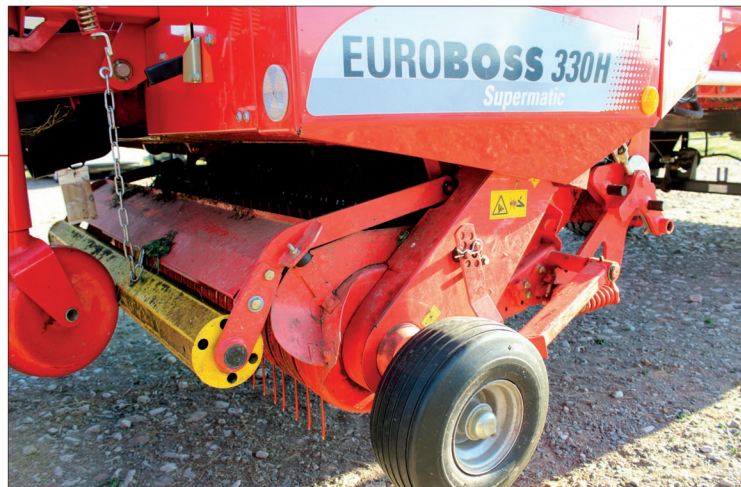
Návěsy Euroboss T/H využívají řízený sběrač s pěti řadami prstů, doplněný o urovnávací váleček. Pomocí vodicích koleček lze nastavovat výšku sbírání nad zemí a podle vyjádření Jiřího Stupky sběrač velmi dobře kopíruje terénní nerovnosti
