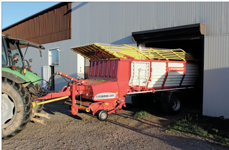
Šikovné řešení samosběracích návěsů Euroboss T/H firmy Pöttinger spočívá v tom, že nástavbu na suchou hmotu lze pomocí hydrauliky traktoru sklopit, čímž se získá malá průjezdní výška vozu. Ten pak může projíždět i vjezdy s omezenou výškou
