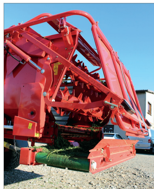
Hydraulicky poháněný zakládací dopravník umí krmivo odkládat vpravo nebo vlevo, anebo v případě nepotřeby může být zasunutý pod návěsem. Hmotu na pás dopravuje dvojice rozdrůzovacích válců
