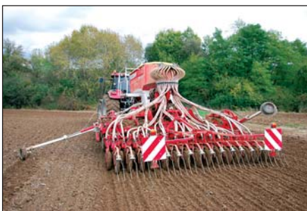
Sejačka Terrasem dobre zaseje aj pri vyššej rýchlosti, preto v Sennom postačuje 4-metrový pracovný záber.
